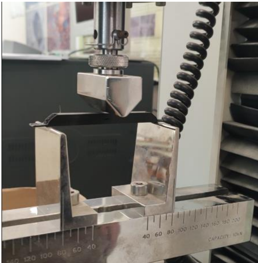
Εικόνα 44 : Μηχανή κάμψης τριών σημείων με τοποθετημένο το δοκίμιο
