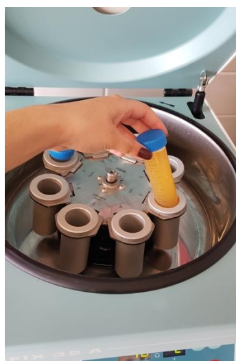
Εικόνα 21 Τοποθέτηση δειγμάτων προς φυγοκέντριση.
