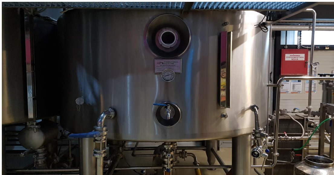
Εικόνα 17 Κεντρικό ζυθοβραστήριο της εταιρίας – Whirlpool.
