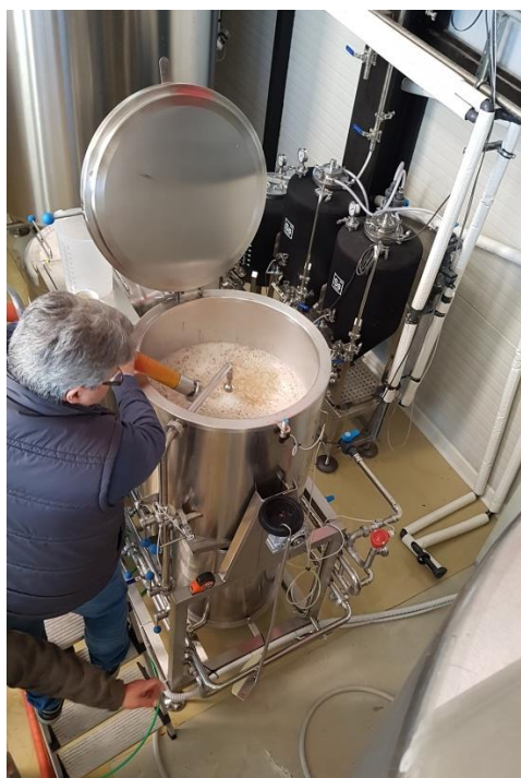
Εικόνα 16 Εισαγωγή του μείγματος νερού και σιτηρών στο πιλοτικό lauter.
