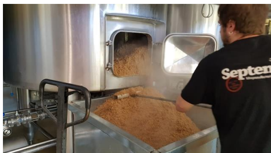
Εικόνα 18 Απομάκρυνση των υπολειμμάτων από το κεντρικό lauter του ζυθοποιείου.
