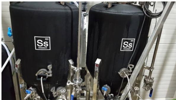
Εικόνα 11 Δεξαμενές ζύμωσης 60 λίτρων
