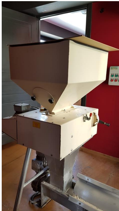
Εικόνα 9 Μηχανικός μύλος σπασίματος της βύνης.
