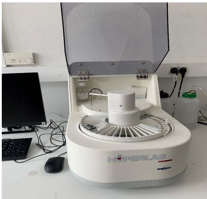
Εικόνα 4: Αναλυτής Hyperlab όπου πραγματοποιήθηκαν οι τελικές μετρήσεις σακχάρων των στελεχών.
