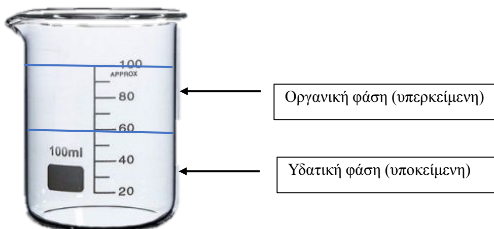
Σχήμα 11: Απεικόνιση της διαδικασίας εκχύλισης, υγρού-υγρού στο ποτήρι ζέσεως
