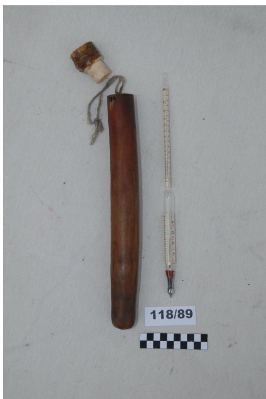
Εικόνα 2: Παραδοσιακό αλκοολόμετρο ή γραδόμετρο από το Μουσείο Κυπριακής Υπαίθρου. Αριστερά είναι λαιμός κολοκυθίου στον οποίο τοποθετούσαν τη ζιβανία ώστε να μετρήσουν τονκτηθή αλκοολικό τίτλο.
