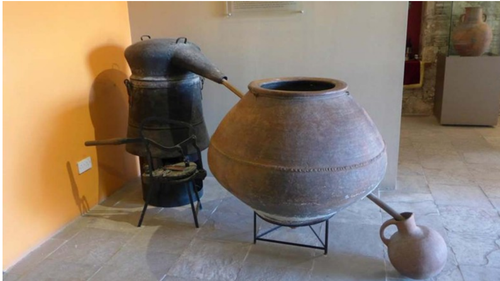
Εικόνα 1: Παραδοσιακή αποστακτική συσκευή για την παραγωγή της ζιβανιά. Έκθεμα του Μουσείου Οίνου στην Κύπρο
