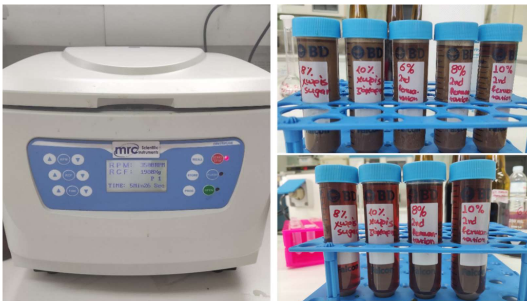
Εικόνα 14: (Αριστερά) Φυγόκεντρος (certifunge, mrc Scientific instruments). (Δεξιά) Πάνω είναι τα δείγματα μύρας μόλις προστέθηκαν ZnSO 4 και Ba(OH) 2 και ξεκινά η καθίζηση πρωτεϊνών, ενώ κάτω είναι μετά την ανάμειξη και φυγοκέντρωση.
