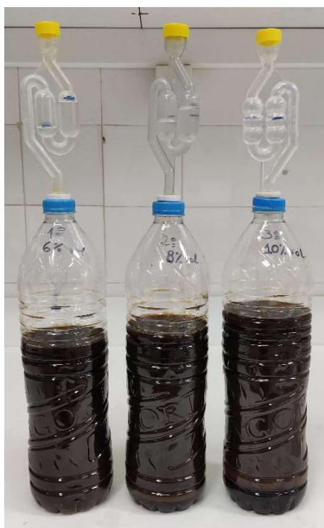
Εικόνα 13: Το βυνογλεύκος μετά την προσθήκη μαγιάς και χαρουπόμελου σε μπουκάλια με αεροπαγίδα (αριστερά) και τα μπουκάλια μύρας μετά την εμφιάλωση (δεξιά).
