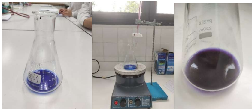
Εικόνα 12: (Αριστερά) διάλυμα Fehling A και B με κυανό του μεθυλενίου. (Κέντρο) το διάλυμα Fehling στη θερμαντική πλάκα και η προχοΐδα με το διάλυμα B. (Δεξιά) Τέλος ογκομέτρησης, έχει εξαφανιστεί ο μπλε χρωματισμός.
