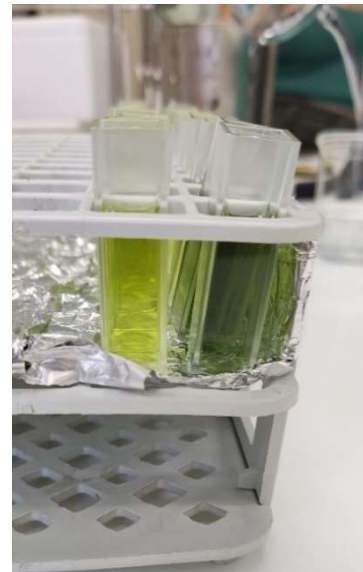
Εικόνα 18: Πορεία διεργασίας Folin-Ciocalteu. Αντιδραστήρια, πιπέτα, κυψελίδες και στατό. Στη δεξιά εικόνα φαίνεται η αλλαγή χρώματος από κίτρινο σε κυανό.
