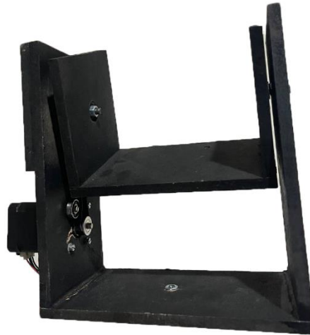
Εικόνα 2. 34 Ένωση κινητών μερών περιστροφής και κλίσης (Pan και Tilt)
