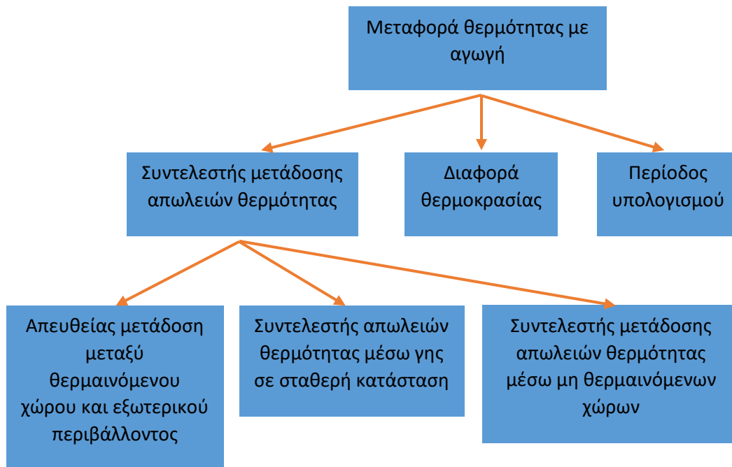
Σχήμα 1.1 – Υπολογισμός μεταφοράς θερμότητας μέσω αγωγής
