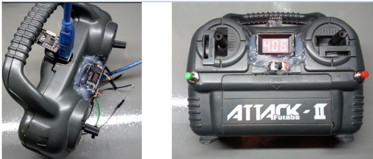
Εικόνα 112 Αριστερά: Η εγκατάσταση του nRF24L01 module και η σειριακή θύρα USB . Δεξιά: Το ολοκληρωμένο χειριστήριο στην τελική του μορφή
