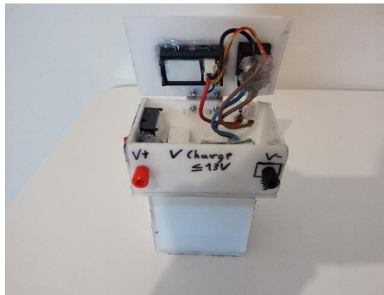
Εικόνα 70 Επικάλυψη των απογυμνωμένων μερών και επαφών με σιλικόνη
