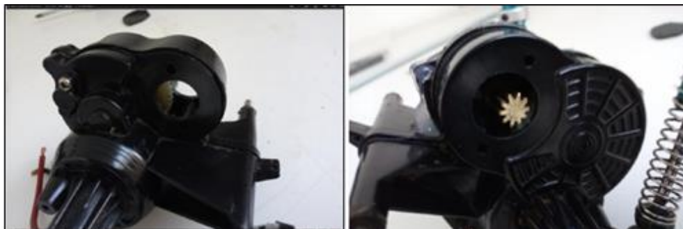
Εικόνα 50 Εγκατάσταση του μοτέρ επάνω στο κιβώτιο μετάδοσης κίνησης.
