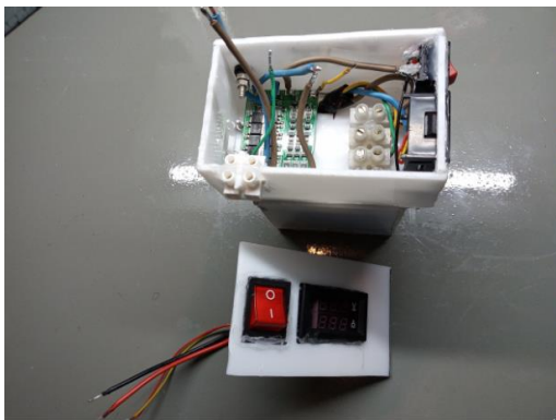
Εικόνα 68 Τοποθέτηση του BMS Protection Board και της κλέμας εξόδου.
