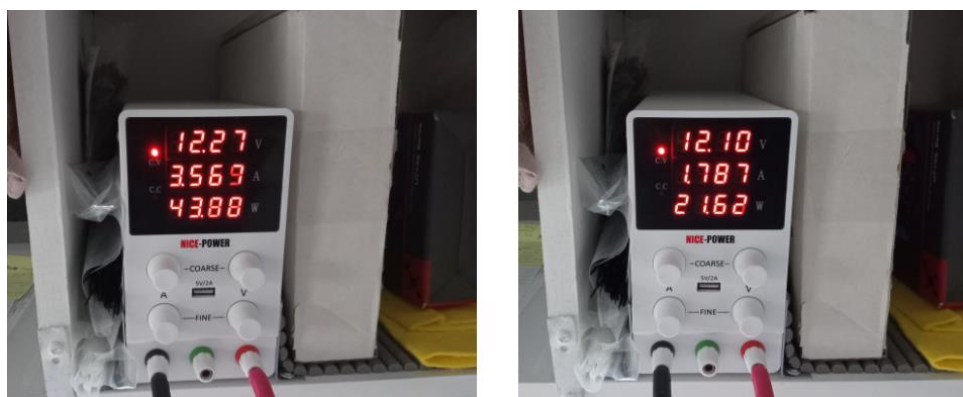
Εικόνα 74 Αριστερά: Φόρτιση των μπαταριών λιθίου. Δεξιά: Το στάδιο πριν την ολοκλήρωση της φόρτισης
