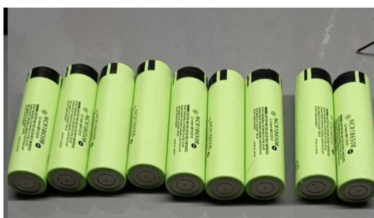
Εικόνα 56 Κελιά τύπου Li-ion Panasonic NCR18650B 3400mAh
