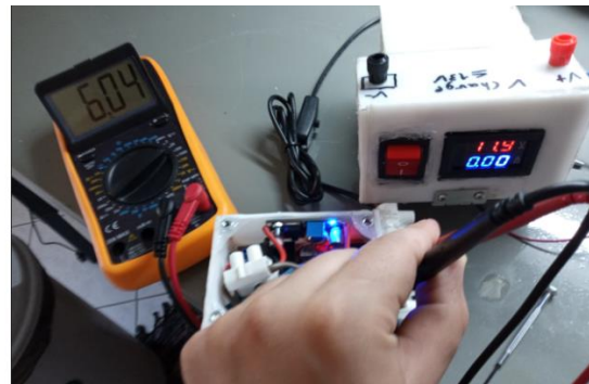
Εικόνα 76 Αριστερά: Τάση εξόδου Stepdown για την τροφοδοσία της H – bridge. Δεξιά: Τάση εξόδου Stepdown για την τροφοδοσία των Servomotor και Arduino.
