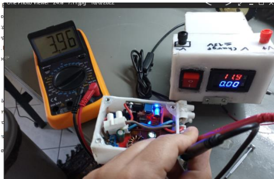
Εικόνα 76 Αριστερά: Τάση εξόδου Stepdown για την τροφοδοσία της H – bridge. Δεξιά: Τάση εξόδου Stepdown για την τροφοδοσία των Servomotor και Arduino.
