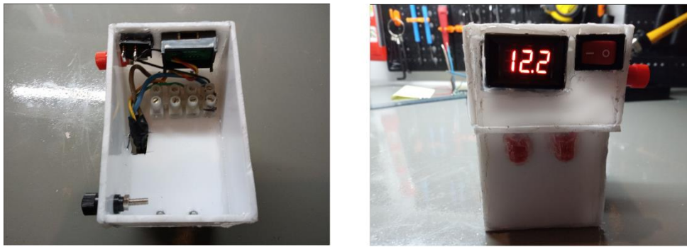
Εικόνα 67 Αριστερά: Το εσωτερικό του άνω μέρους της θήκης και στο πίσω μέρος οι μπόρνες τροφοδοσίας. Δεξιά: Ο διακόπτης ON – OFF ,το βολτόμετρο με την ένδειξη της τιμής φόρτισης.
