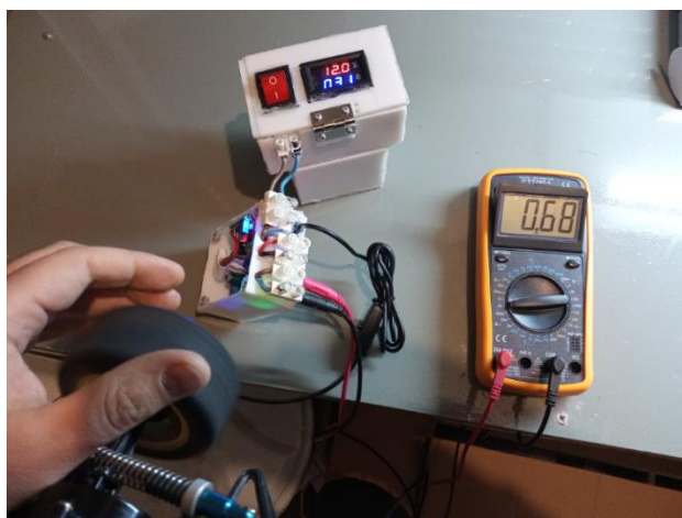
Εικόνα 77 Αριστερά: Μέτρηση της εντάσεως του μοτέρ χωρίς φορτίο (ζητούμενο ρεύμα στα 0,680A), Δεξιά: Μέτρηση της εντάσεως του μοτέρ με πλήρες φορτίο ( ζητούμενο ρεύμα στα 7,61A).
