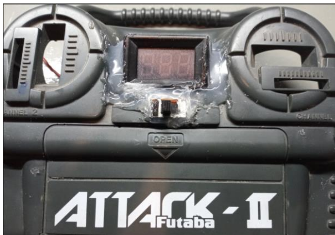
Εικόνα 106 Προσαρμογή του διακόπτη και της οθόνης LED στο χειριστήριο
