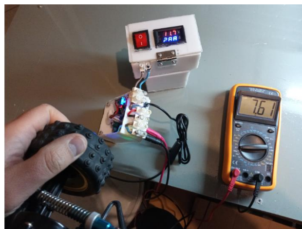
Εικόνα 77 Αριστερά: Μέτρηση της εντάσεως του μοτέρ χωρίς φορτίο (ζητούμενο ρεύμα στα 0,680A), Δεξιά: Μέτρηση της εντάσεως του μοτέρ με πλήρες φορτίο ( ζητούμενο ρεύμα στα 7,61A).
