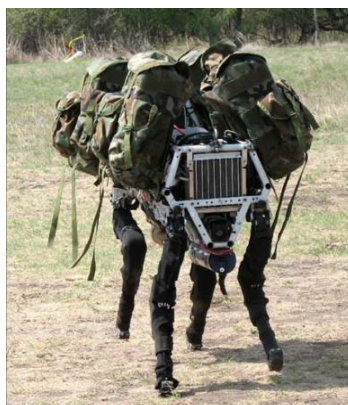
Εικόνα 29 Τετράποδο ρομπότ "BigDog" το οποίο αναπτύχθηκε για να κουβαλάει φορτίο διασχίζοντας ανώμαλο έδαφος [83]
