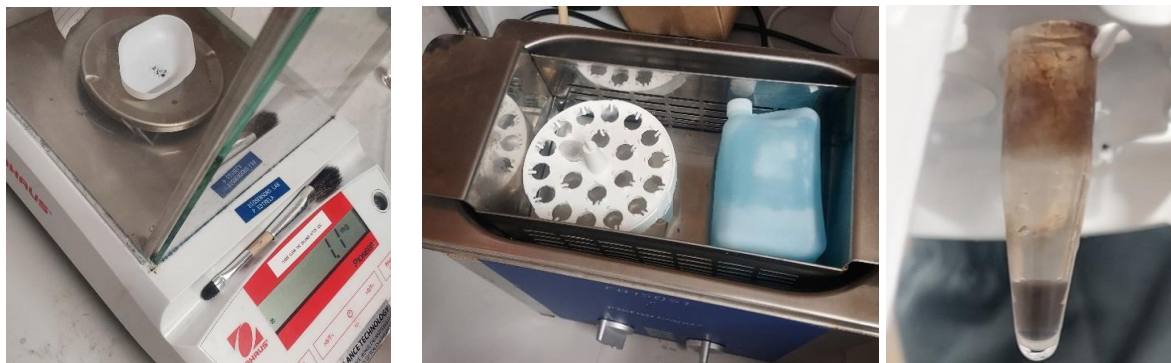
Σχήμα 17. (Α) 1.1mg CuO (Β) Μίξη του διαλύματος στο Sonicator (Γ) Τελικό διάλυμα
