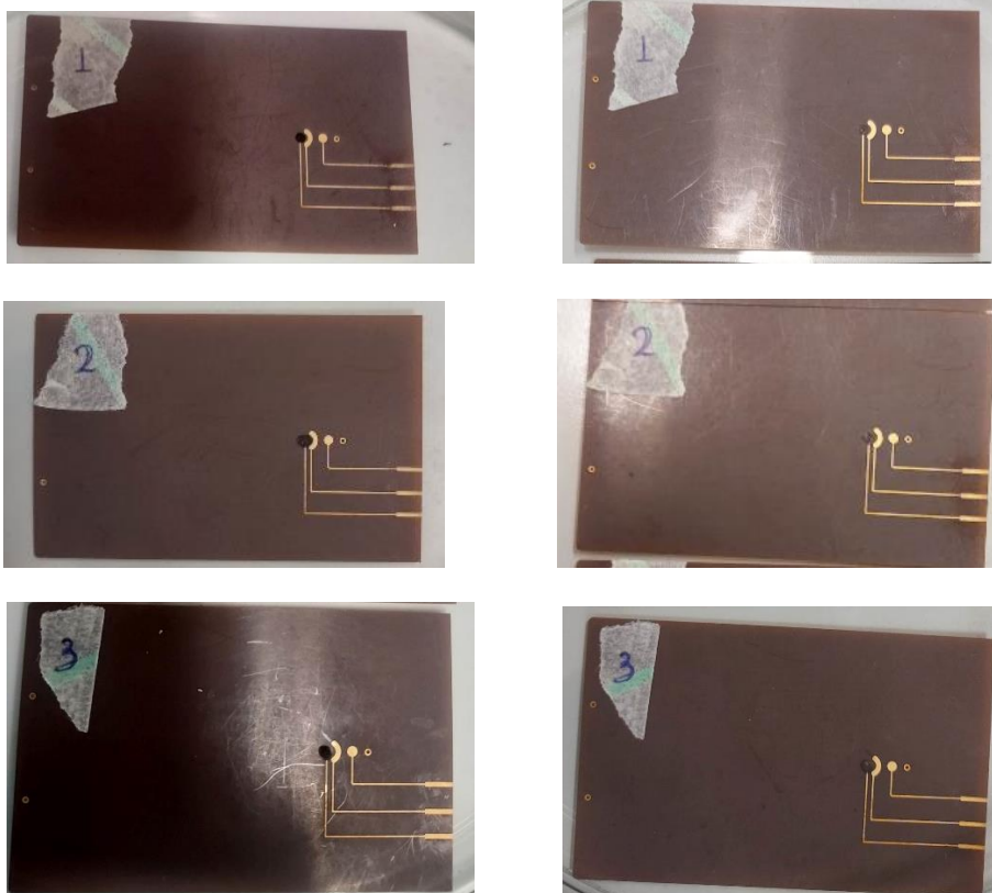
Σχήμα 41. Αριστερά: Υπόστρωμα πριν τις μετρήσεις. Δεξιά: Υπόστρωμα μετά τις μετρήσεις.
