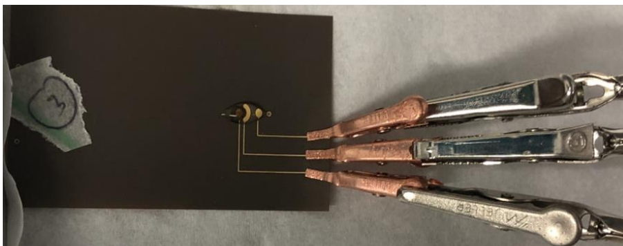
Σχήμα 20. Αμπερομετρική διάταξη με γλυκόζη στα ηλεκτρόδια.
