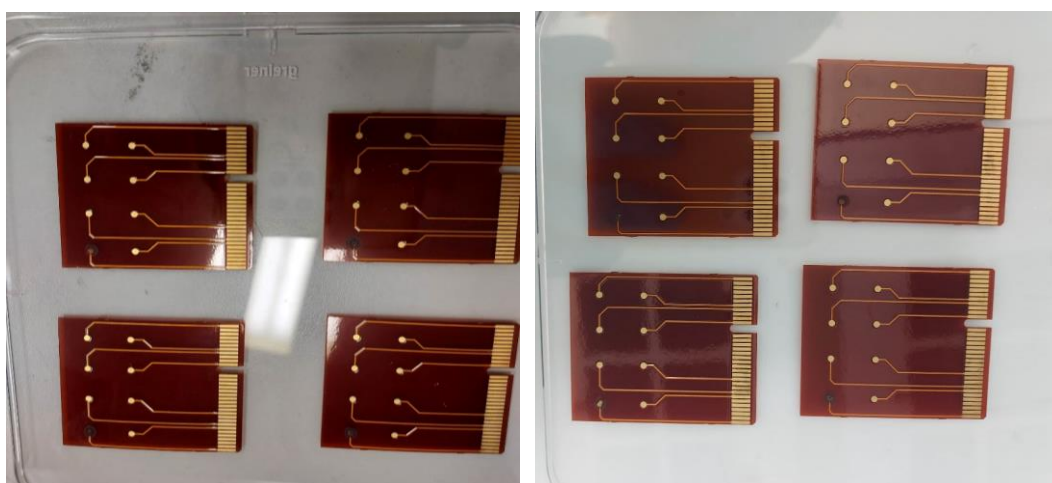
Σχήμα 105. Αριστερά: Υποστρώματα πριν την βύθιση σε MQ νερό. Δεξιά: Υποστρώματα μετά την βύθιση σε MQ νερό.
