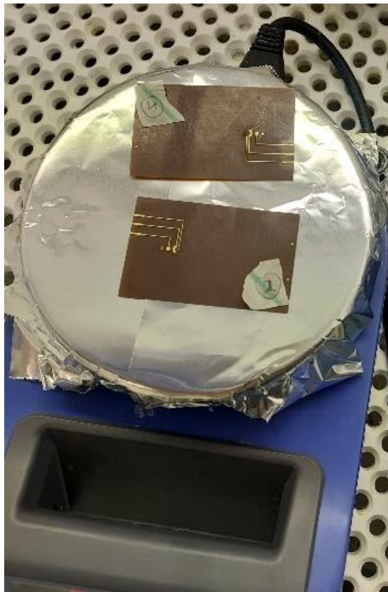
Σχήμα 18. Υποστρώματα με CuO στο ηλεκτρόδιο εργασίας. Υπόστρωμα 1: ΠΑΝΩ Υπόστρωμα 2: ΚΑΤΩ.
