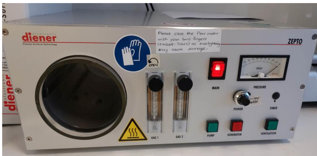
Σχήμα 22. Θάλαμος πλάσματος οξυγόνου (Diener Zepto System, Diener electronic, Ebhausen, Germany)
