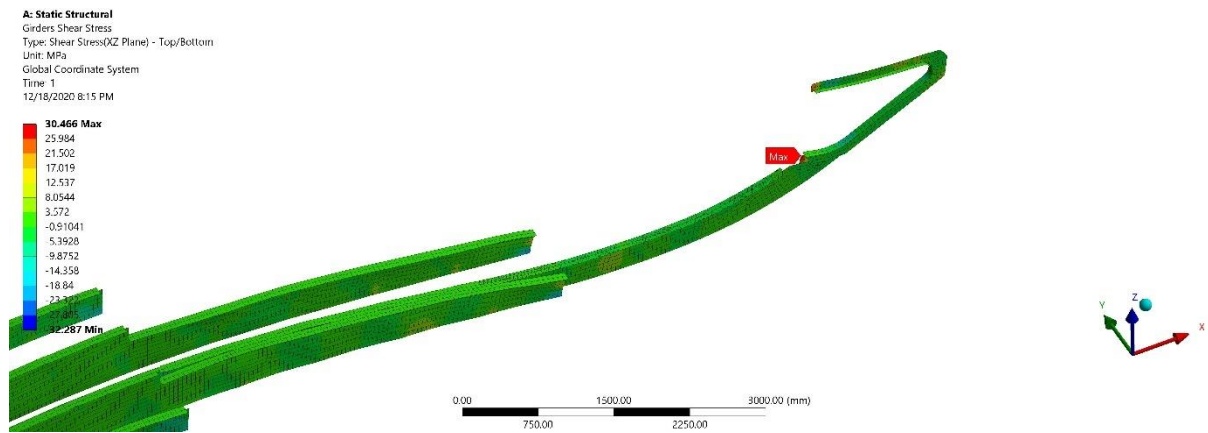
Εικόνα 115: Διατμητικές τάσεις στα κύρια ενισχυτικά του πυθμένα (πλωραίο τμήμα)
