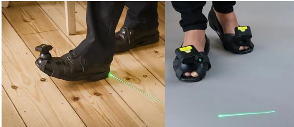
Σχήμα 6: Απεικόνιση των εξαρτημάτων παπουτσιών με λέιζερ για ασθενείς με νόσο του Πάρκινσον [20].
