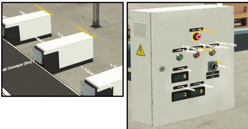
Εικόνα 71 : Ψηφιακή απεικόνιση του Factory I/O - των ωθητήρων, του πίνακα ελέγχου και των αισθητήρων όρασης και φωτοαισθητήρων.
