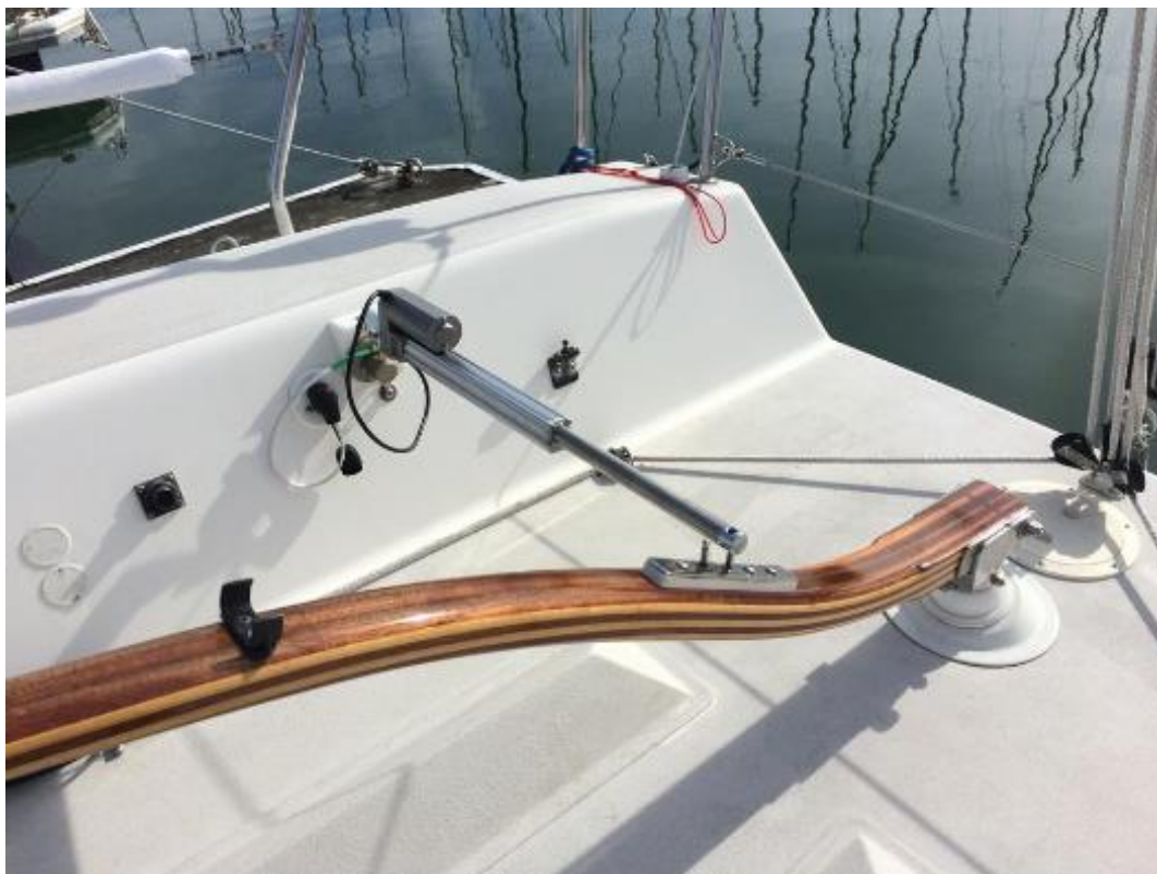
Εικόνα 4.2-Στάνταρ Electronic Tiller Pilot [28]
