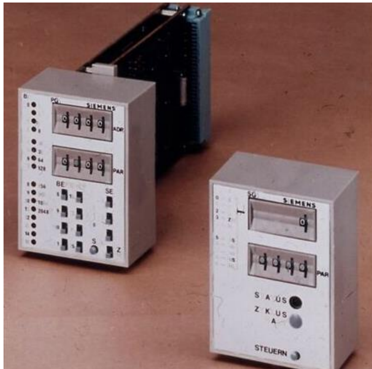
Εικόνα 5.3-Simatic s3 switch with programable head [59]
