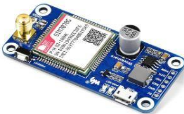
Εικόνα 22 - Πλακέτα Waveshare NB-IoT/Cat-M/GPRS/GNSS HAT – SIM7070G 18
