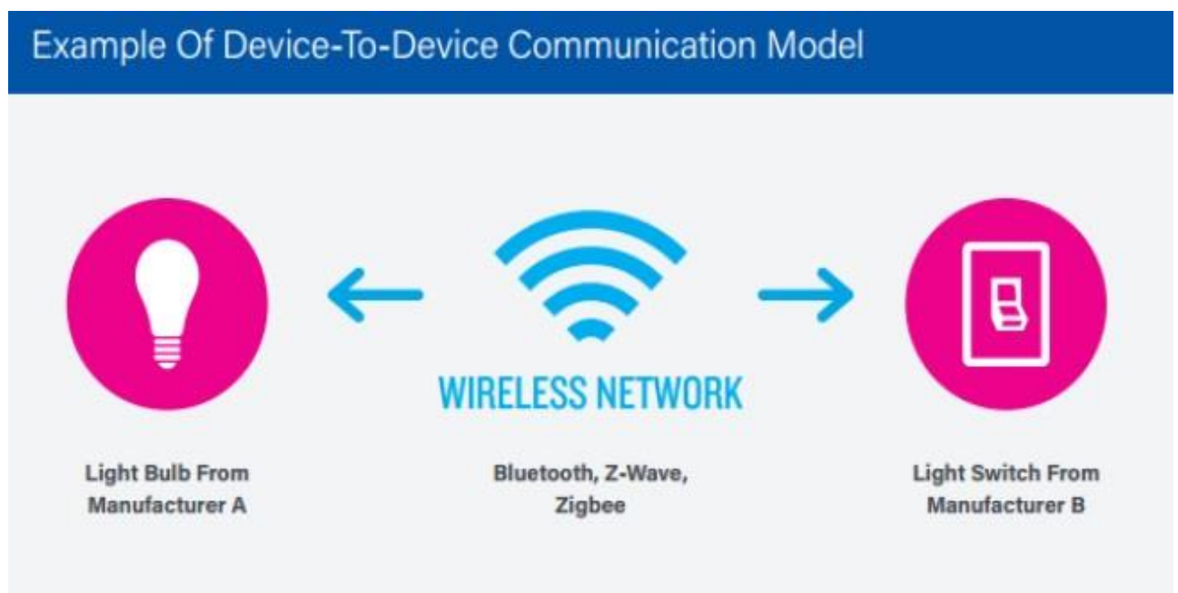
Εικόνα 10 - Μοντέλο επικοινωνίας Device to Device[14]
