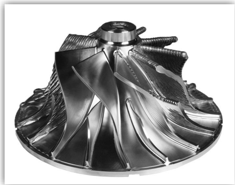
Εικόνα 4-6. Πτερωτή κατασκευασμένη με WAAM κατά την τελική επιφανειακή επεξεργασία. (LASER WELDING SOLUTIONS, n.d.)
