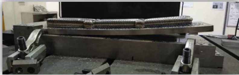
Εικόνα 2-3. Παράδειγμα παραμόρφωσης και παραμένουσας τάσης σε προϊόν WAAM.(Cunningham et al., 2018)
