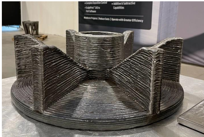
Εικόνα 2-1. Προϊόν WAAM όπου απαιτείται επιφανειακή κατεργασία. (ZELINSKI, 2022)
