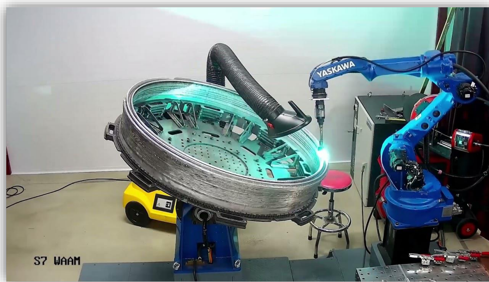
Εικόνα 4-1. Διάταξη WAAM με ρομποτικό βραχίονα και βάση πολλών αξόνων από τη YASKAWA. (YASKAWA, n.d.)
