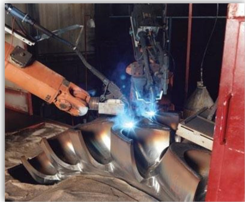
Εικόνα 4-7. Πτερωτή υδροστροβίλου Pelton κατά την κατασκευή της με WAAM. (Posch et al., 2014)
