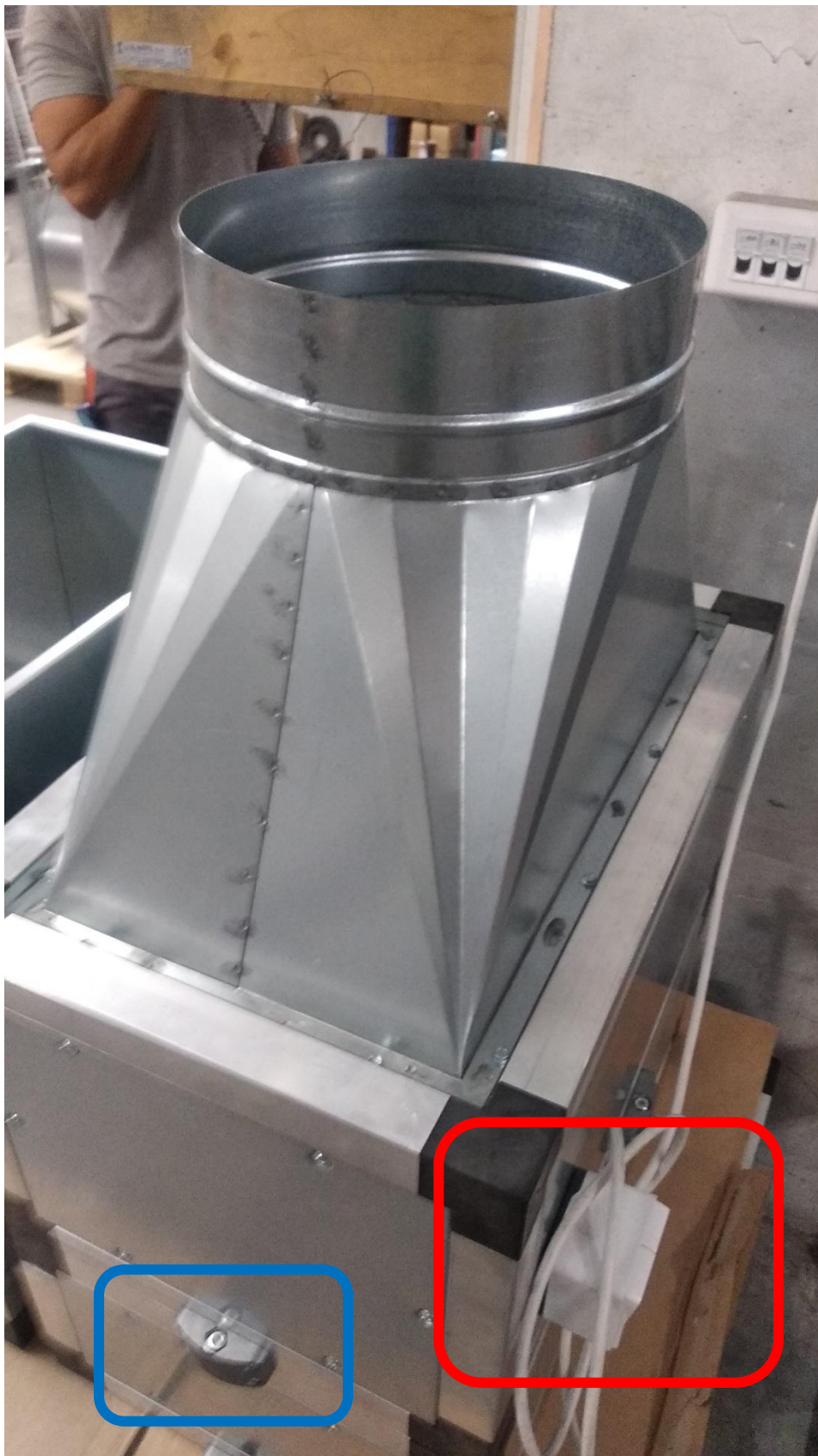
Η μονάδα εξαγωγής του αέρα, όπου φαίνεται ο διακόπτης έναρξης και τερματισμού της λειτουργίας του (Κόκκινο χρώμα)
