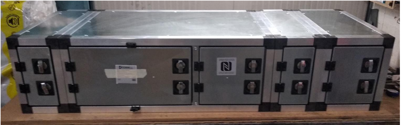
Η Φιλτρομονάδα υπό συναρμολόγηση
