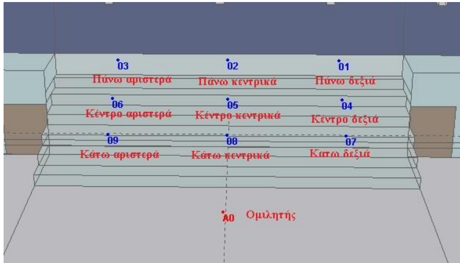
Εικόνα 73: Γραφική αναπαράσταση μέσω του CATT-Acoustic των 9 θέσεων στις κερκίδες για τις οποίες υλοποιήθηκαν οι προσομοιώσεις. Τα σημεία είναι αντίστοιχα με αυτά των μετρήσεων μέσω του REW.
