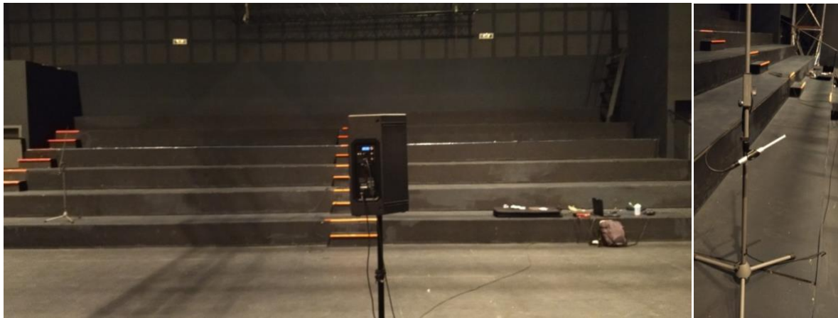
Εικόνα 63: (Αριστερά) Τοποθέτηση ηχείου στο κέντρο της σκηνής με κατεύθυνση προς το ακροατήριο.
