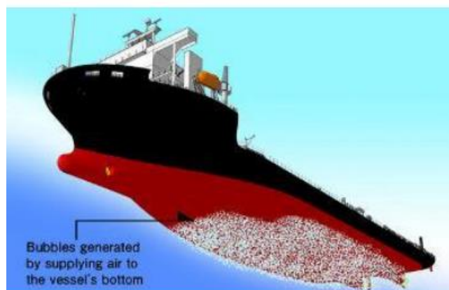
Εικόνα 34 : Φυσαλίδες αέρα στο κύτος του πλοίου [7]
