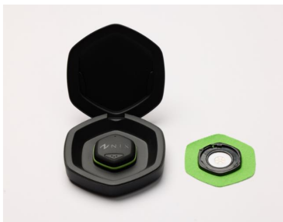
Εικόνα 2.8. Φορητή συσκευή Nix Biosensor βιοαισθητήρα που αναλύει τον ιδρώτα και καταγράφει μια προσωπική στρατηγική ενυδάτωσης σε πραγματικό χρόνο.
