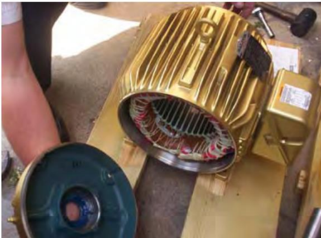
Εικόνα 14 Αφαίρεση της έτερης πλάκας του κινητήρα [15]
