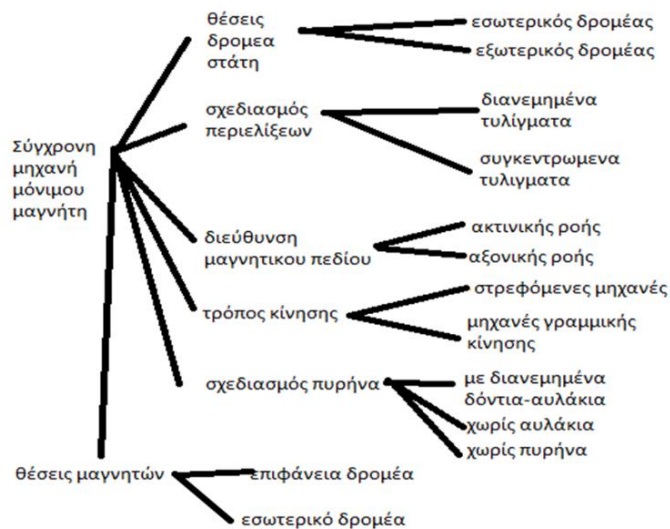
Σχήμα 2.7 Παραμετρικός σχεδιασμός μηχανής μόνιμων μαγνητών
