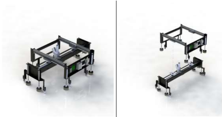
Εικόνα 57: Πρωτότυπο ρομπότ αμμοβολής
