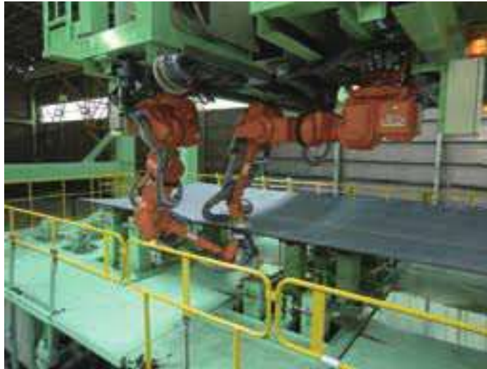
Εικόνα 53: Ρομποτικό σύστημα θέρμανσης
