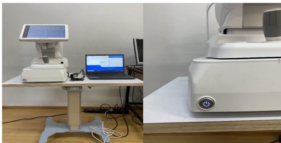
Εικόνα 19: Σύστημα OCT με φορητό υπολογιστή και ειδικό τραπέζι εξέτασης (αριστερά). Κουμπί βασικής εκκίνησης συστήματος (δεξιά)
