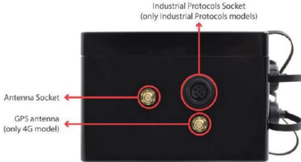
Εικόνα 3.2: Αριστερή πλευρά κεντρικού οργάνου Libelium
