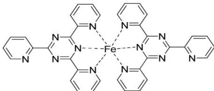
Εικόνα 31: Δομή του συμπλόκου του σιδήρου με TPTZ
