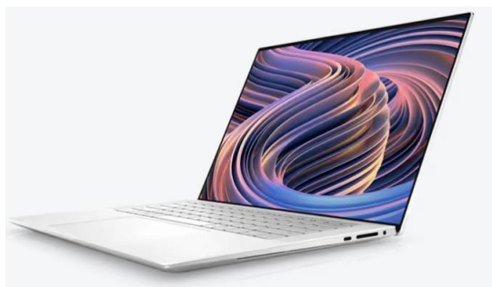
Εικόνα 9 Notebook Dell με ελάχιστους χώρους για εξαναγκασμένη συναγωγή
