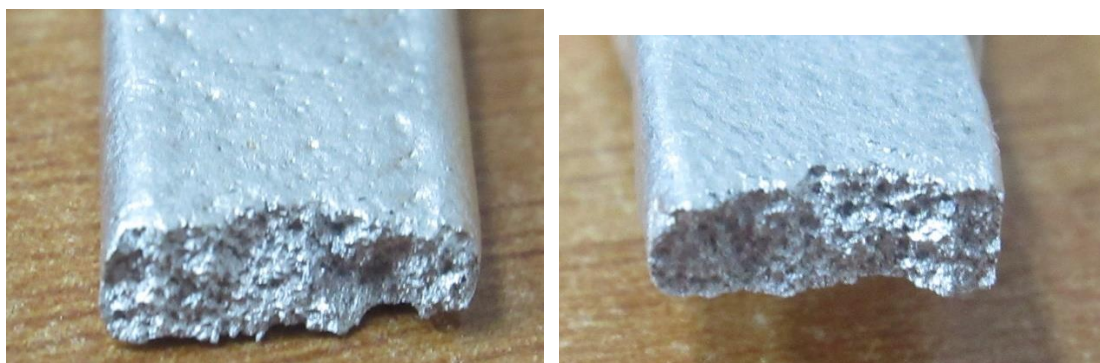
Εικόνα 5.13 Εγκάρσια τομή (μετά τη θραύση) δοκιμίου αλουμινίου περιεκτικότητας 5% κ.β. σε flakes χαλκού, που υποβλήθηκε σε μονοαξονικό εφελκυσμό
