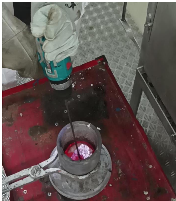
Εικόνα 4.45 Ανάδευση νιφάδων χαλκού (15% κ.β) στο τήγμα αλουμινίου (85%κ.β) με ηλεκτρικό αναδευτήρα
