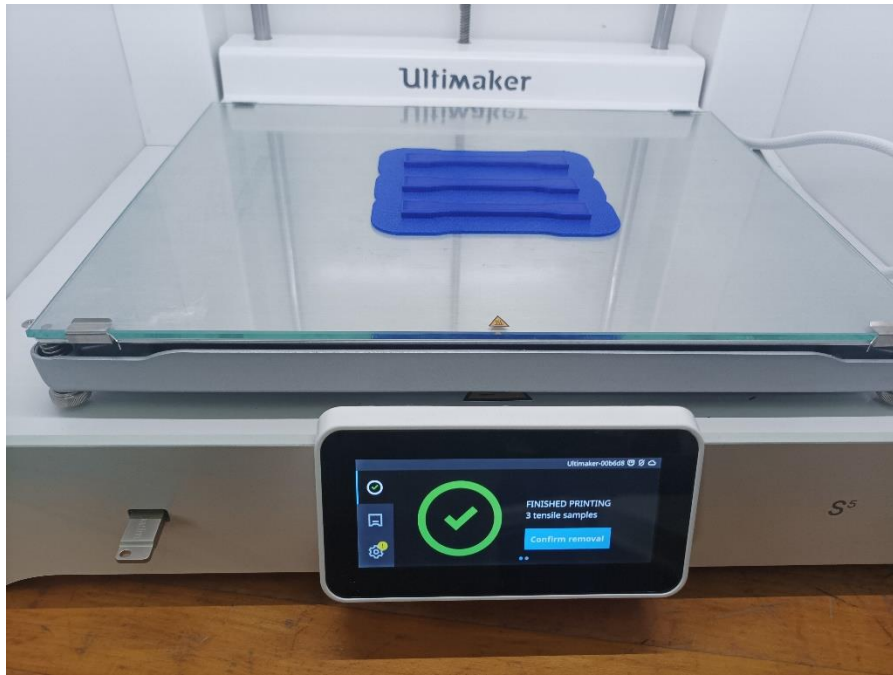
Εικόνα 4.9 Τρισδιάστατη εκτύπωση πρότυπων δοκιμών εφελκυσμού (ολοκλήρωση εκτύπωσης)
