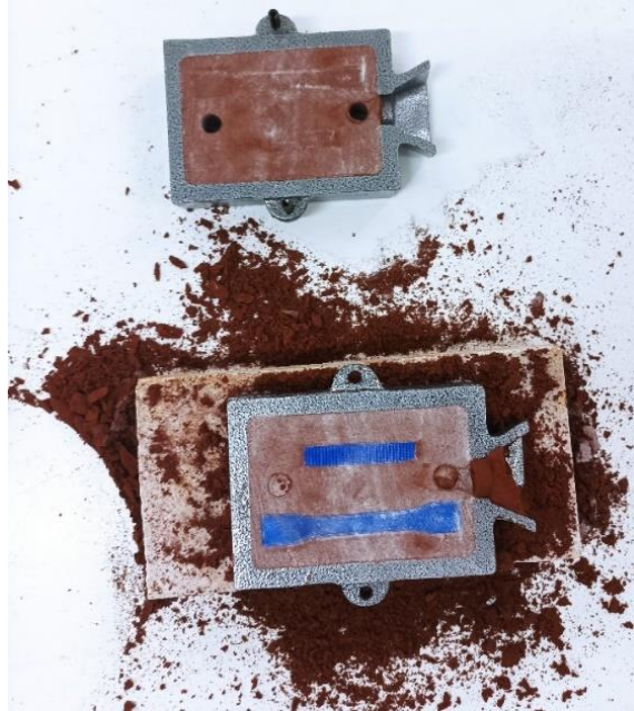
Εικόνα 4.27 Γέμισμα με άμμο του πάνω πλαισίου του καλουπιού
