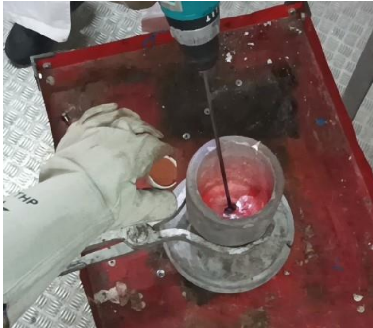
Εικόνα 4.44 Έγχυση νιφάδων χαλκού (15%κ.β.) στο λιωμένο αλουμίνιο
