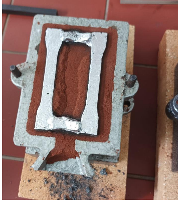
Εικόνα 4.33 Άνοιγμα 1 ο καλουπιού με τα δύο δοκίμια εφελκυσμού (5% κ.β. Cu)
