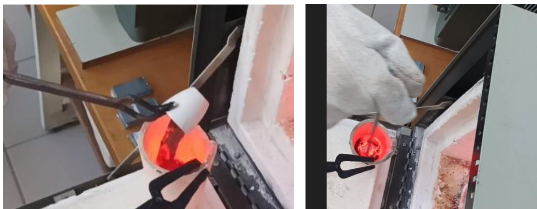
Εικόνα 4.37 Έγχυση νιφάδων χαλκού (15% κ.β) στο τήγμα αλουμινίου (85%κ.β) (αριστερά) και ανάδευση (δεξιά)
