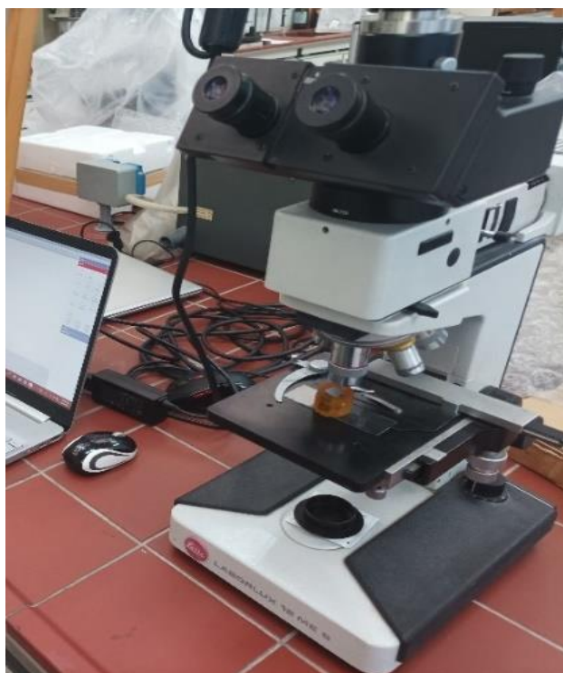
Εικόνα 5.16 Μικροσκόπιο LABORLUX 12 ME S και διάταξη μικροσκοπίου – κάμερας – υπολογιστή
