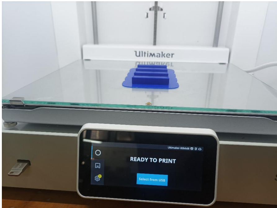
Εικόνα 4.13 Τρισδιάστατη εκτύπωση πρτύπων δοκιμών κρούσης (ολοκλήρωση εκτύπωσης)
