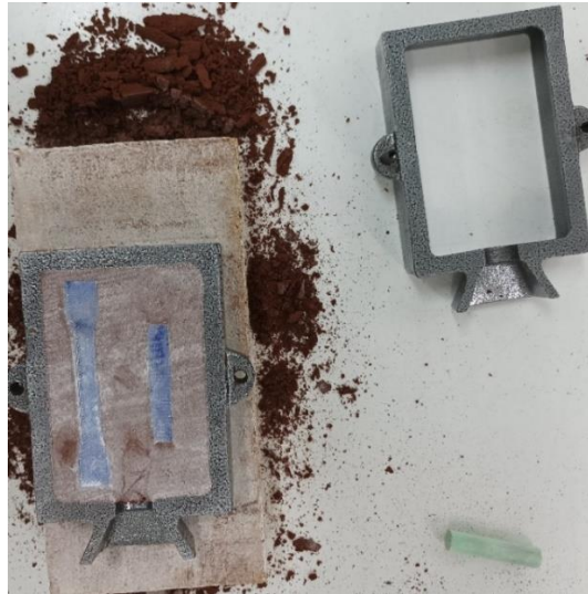
Εικόνα 4.25 Γέμισμα με άμμο του κάτω πλαισίου του καλονπιού
