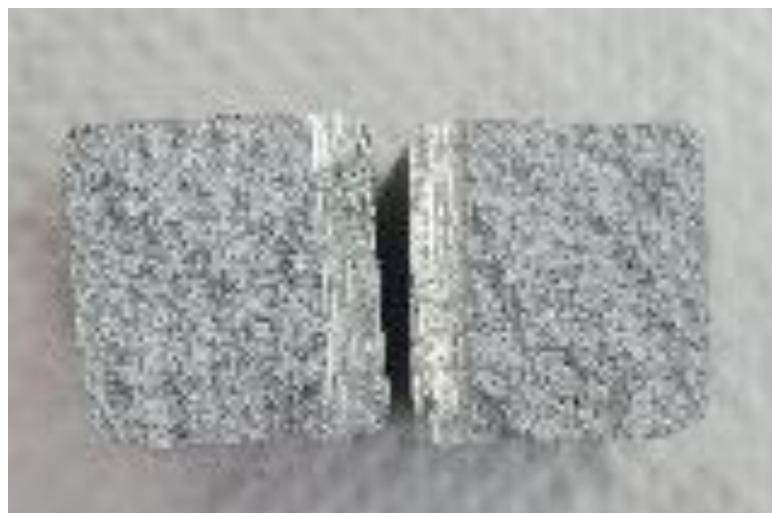
Εικόνα 5.10 Δοκίμια αλουμινίου περιεκτικότητας 15% κ.β. σε flakes χαλκού μετά τη δοκιμασία αντοχής σε κρούση (2 η κατασκευή)
