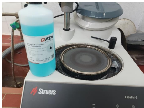
Εικόνα 5.20 Diamond Lubricant Oil για χρήση στο λειαντικό τροχό
