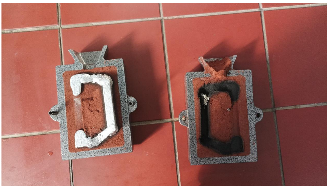
Εικόνα 4.41 Άνοιγμα 3 ου καλουπιού με ένα δοκίμιο κρούσης και ένα δοκίμιο εφελκυσμού (15% κ.β. Cu)
