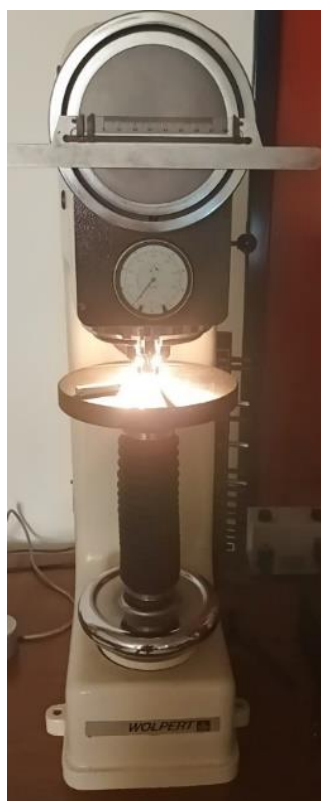
Εικόνα 5.31 Σκληρόμετρο WOLPERT (μέθοδος Vickers) που χρησιμοποιήθηκε για τη σκληρομέτρηση των δοκιμίων
