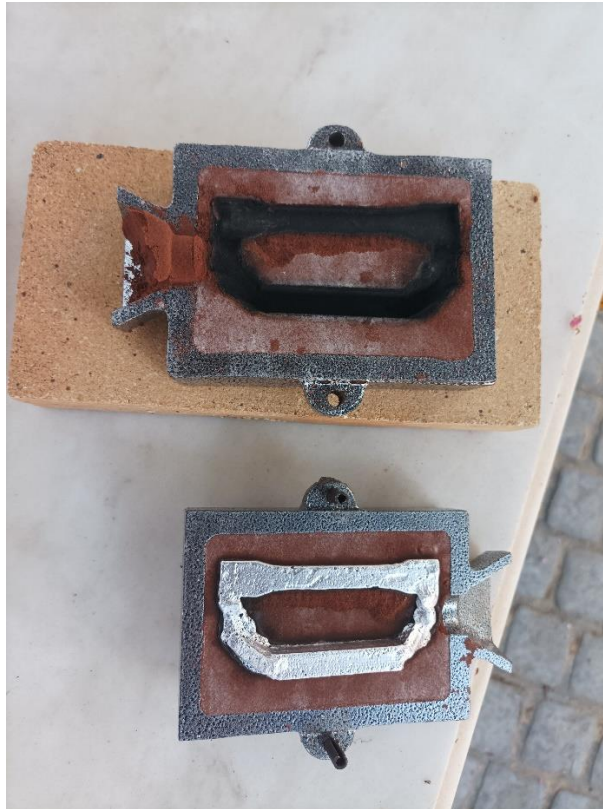
Εικόνα 4.35 Άνοιγμα 3 ου καλουπιού με ένα δοκίμιο κρούσης και ένα δοκίμιο εφελκυσμού (5% κ.β. Cu)
