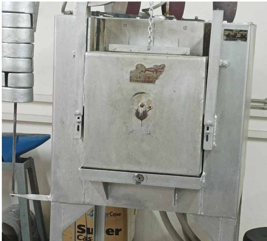
Εικόνα 4.43 Ηλεκτρικός φούρνος χύτευσης στο εργαστήριο χύτευσης του ΕΜΠ
