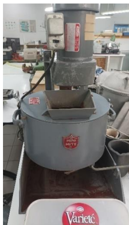
Εικόνα 4.23 Ανάδευση άμμου στον ηλεκτρικό αναδευτήρα
