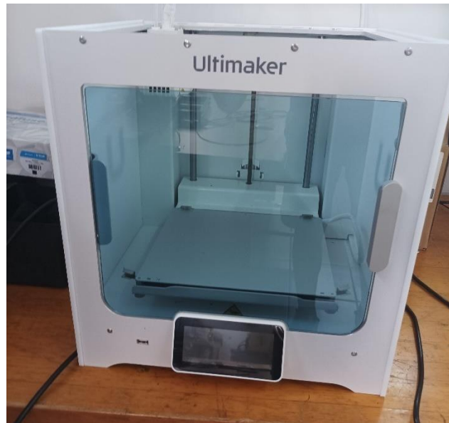
Εικόνα 4.5 Εκτυπωτής 3D UltiMaker S5
