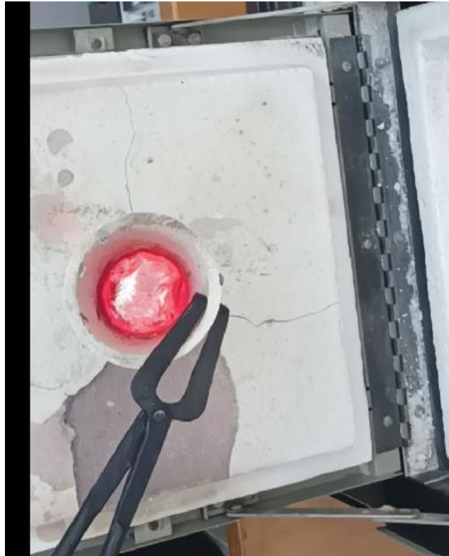
Εικόνα 4.31 Τήγμα 95% κ.β. αλουμινίου και 5% κ.β νιφάδων χαλκού μετά από ανάδευση, έτοιμο για έγχυση στο καλούπι
