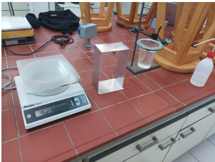
Εικόνα 5.32 Διάταξη πειραματικής μέτρησης πυκνότητας
