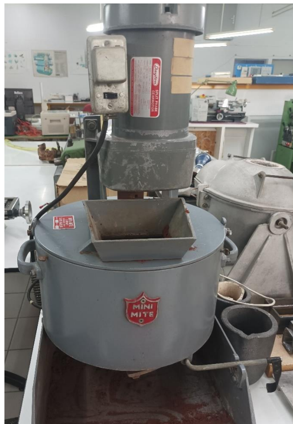
Εικόνα 4.19 Ηλεκτρικός αναδευτήρας άμμου Mini – Mite Sand Muller Model
