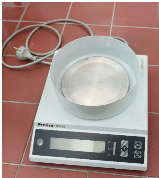
Εικόνα 4.21 Ζυγός ακριβείας Presica 800 M
