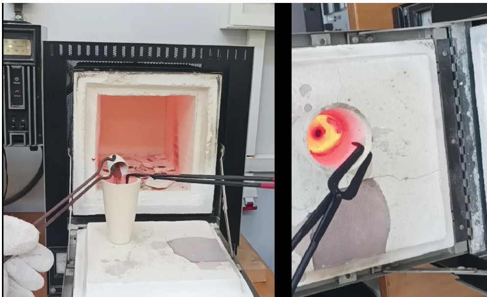
Εικόνα 4.30 Έγχυση νιφάδων χαλκού (5% κ.β) στο τήγμα αλουμινίου (95%κ.β) (αριστερά) και ανάδευση (δεξιά)
