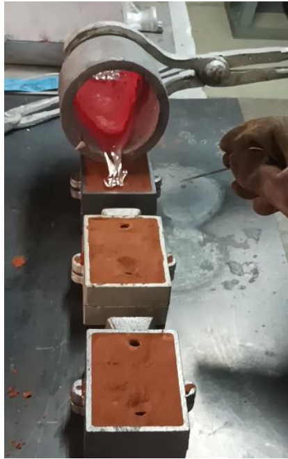
Εικόνα 4.46 Έγχυση τήγματος (15% Cu κ.β. και 85% Al κ.β.) στα καλούπια
