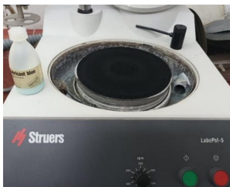
Εικόνα 5.21 Μείγμα αδαμαντόπαστας – λιπαντικού σε βελούδινο λιπαντικό δίσκο
