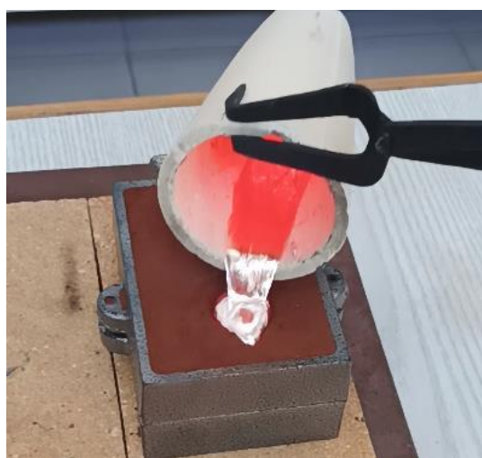
Εικόνα 4.38 Έγχυση τήγατος (15% Cu κ.β. και 85% Al κ.β.) στο καλούπι
