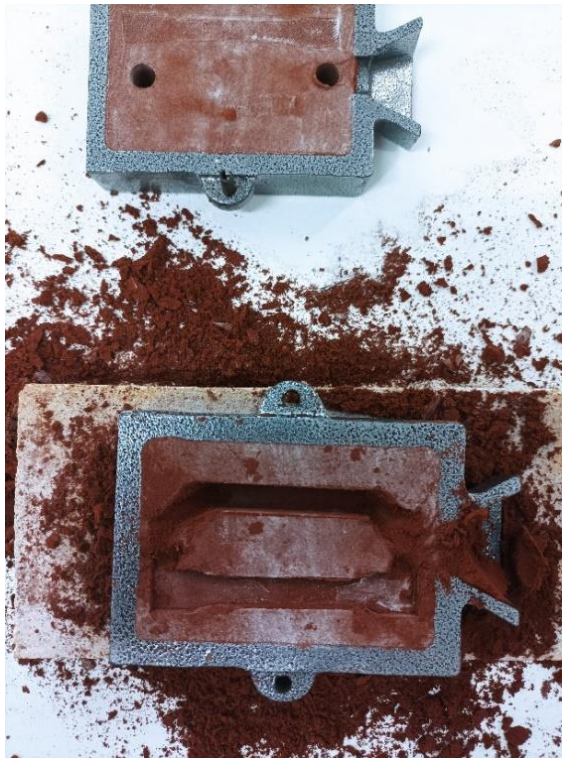
Εικόνα 4.28 Απομάκρυνση μοντέλων και διάνοιξη λεπτών διόδων
