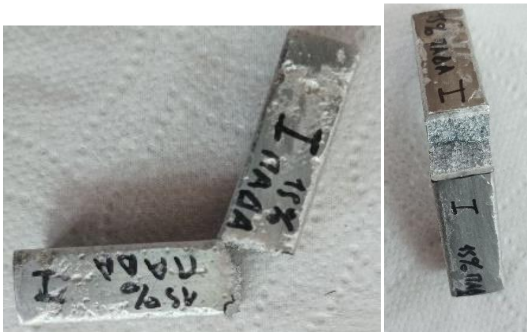
Εικόνα 5.7 Δοκίμια αλουμινίου περιεκτικότητας 15% κ.β. σε flakes χαλκού μετά τη δοκιμασία αντοχής σε κρούση (1 η κατασκευή)
