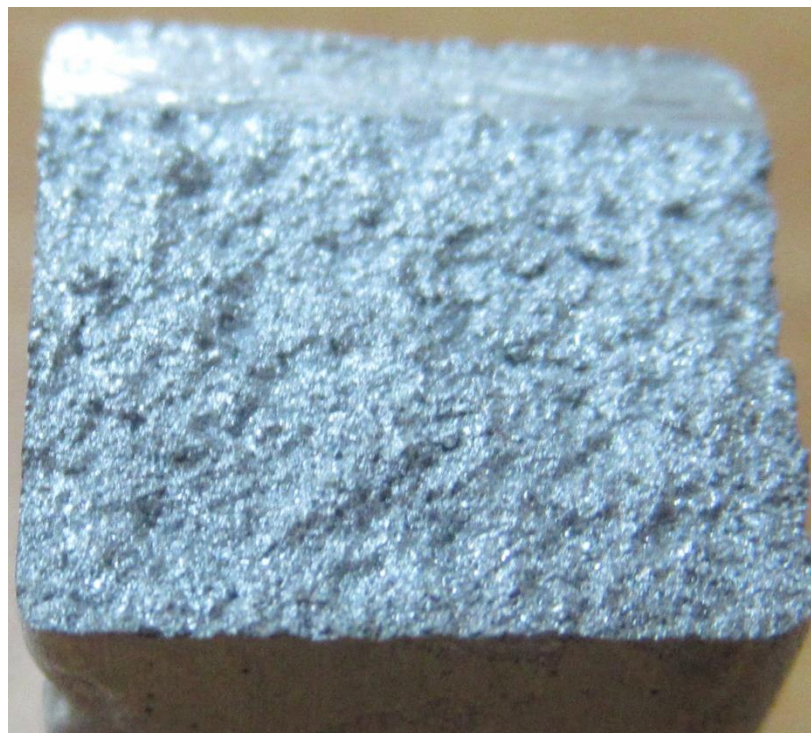
Εικόνα 5.9 Δοκίμια αλουμινίου περιεκτικότητας 15% κ.β. σε flakes χαλκού μετά τη δοκιμασία αντοχής σε κρούση (2 η κατασκευή)
