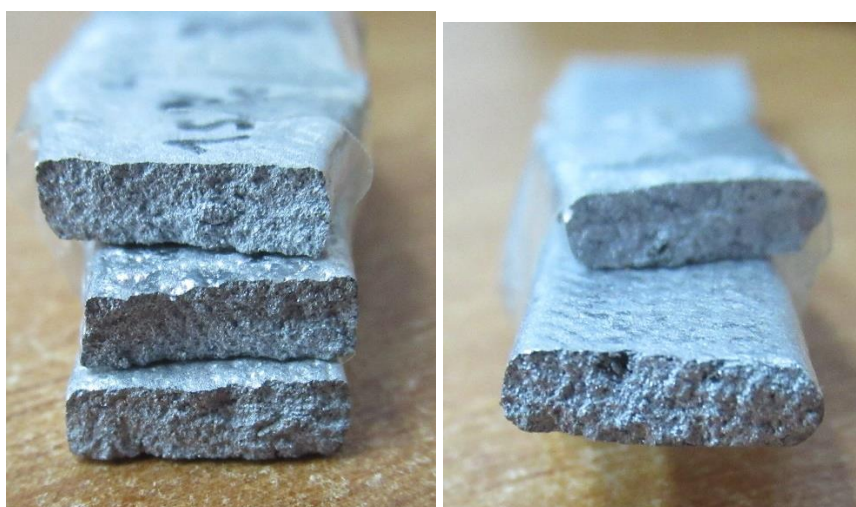
Εικόνα 5.15 Εγκάρσια τομή (μετά τη θραύση) δοκιμίου αλουμινίου περιεκτικότητας 15% κ.β. σε flakes χαλκού, που υποβλήθηκε σε μονοαξονικό εφελκυσμό
