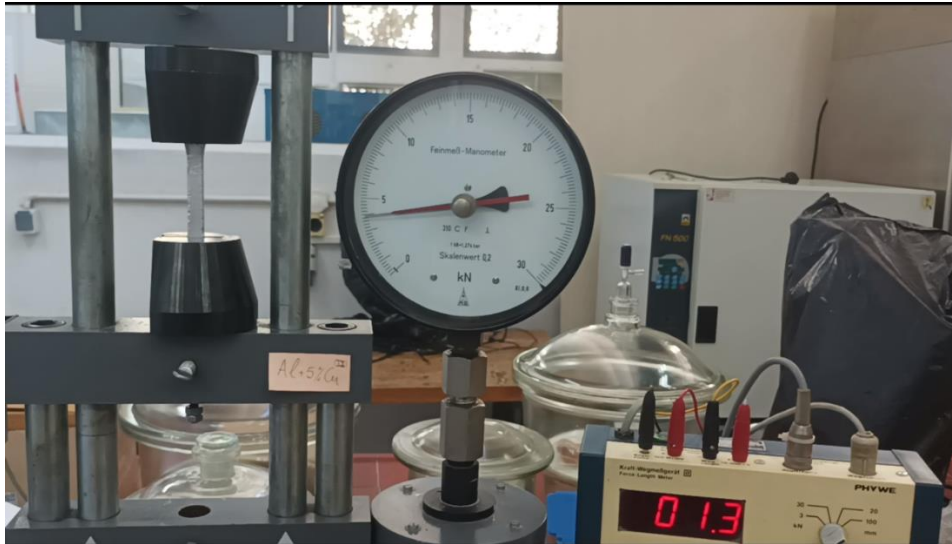
Εικόνα 5.12 Πειραματική διάταξη δοκιμασίας εφελκυσμού
