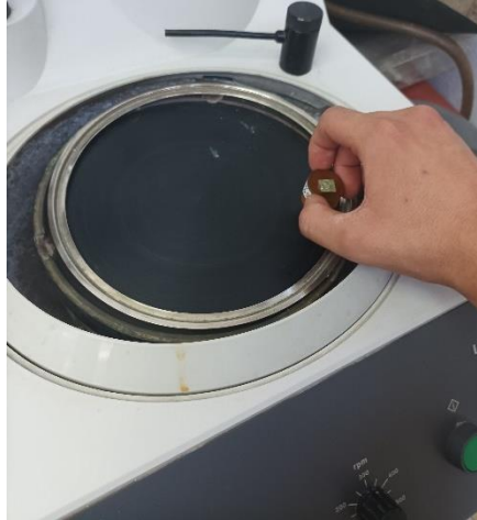
Εικόνα 5.19 Λείανση εγκιβωτισμένων δοκιμίων στο λειαντικό τροχό
