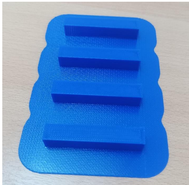
Εικόνα 4.14 Εκτυπωμένα πρότυπα δοκιμα κρούσης
