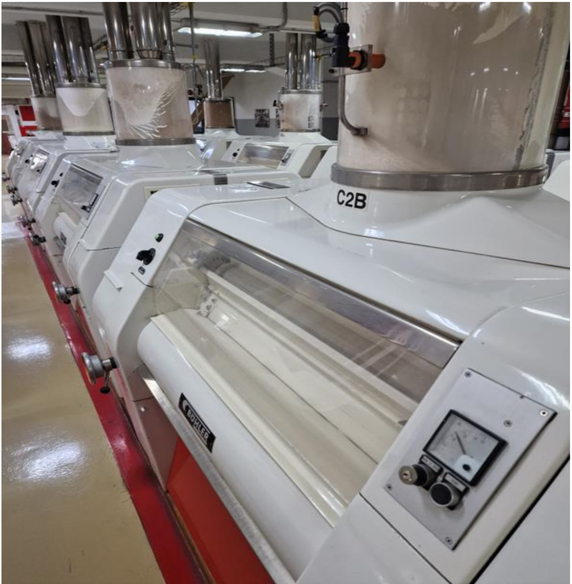
Εικόνα 9. Εξωτερική απεικόνιση - ζεύγη κυλίνδρων.
