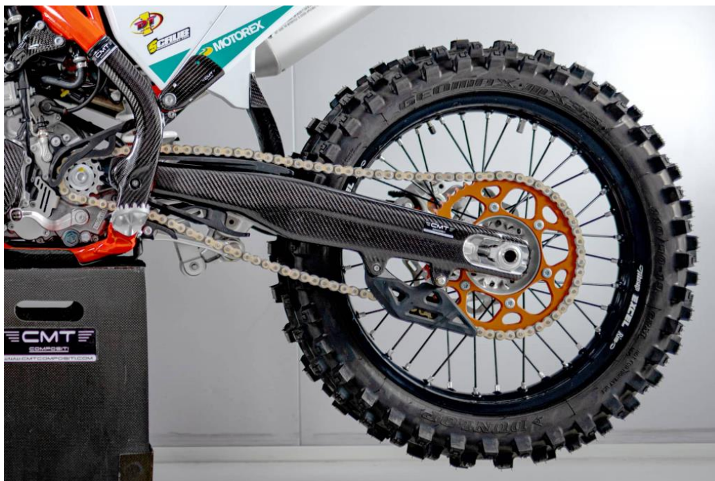
Εικόνα 5: Πίσω βραχίονας και αλυσίδα κίνησης όπως στις περισσότερες μοτοσυκλέτες επιδόσεων εκτός δρόμου.
