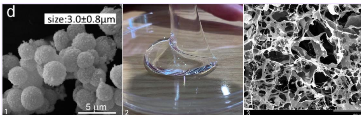
Εικόνα 1.1: Εικόνα ηλεκτρονιακής μικροσκοπίας σάρωσης (SEM) από μικροκάψουλες ανθρακικού ασβεστίου και κοίλου αλγινικού αργύρου που συντέθηκαν με την χρήση μαγνητικού αναδευτήρα, Πηγή: (Feyzmanesh κ.ά., 2022), Εικόνα 1.2: Υδρογέλη, Πηγή: (Bill Fraser, Product Development Scientist, Scapa Healthcare, 2021), Εικόνα 1.3: SEM υδρογέλης αλγινικού στα 50 μm, Πηγή: (Lengert κ.ά., 2017).
