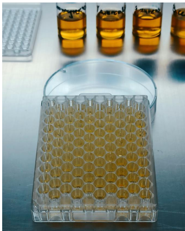
Εικόνα 2: Πλακέτα κυψελίδων (Honeycomb microplate) Bioscreen C, με υγρό υπόστρωμα BHI broth, δείγματα αντιμικροβιακών υδρογελών και στελέχη μικροοργανισμών από την παρούσα ερευνητική μελέτη.
