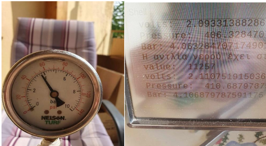
Εικόνα 4.24 Μέτρηση μανόμετρου αφού ανοίξει η αντλία. Εικόνα 4.25 Μέτρηση Raspberry Pi αφού ανοίξει η αντλία
