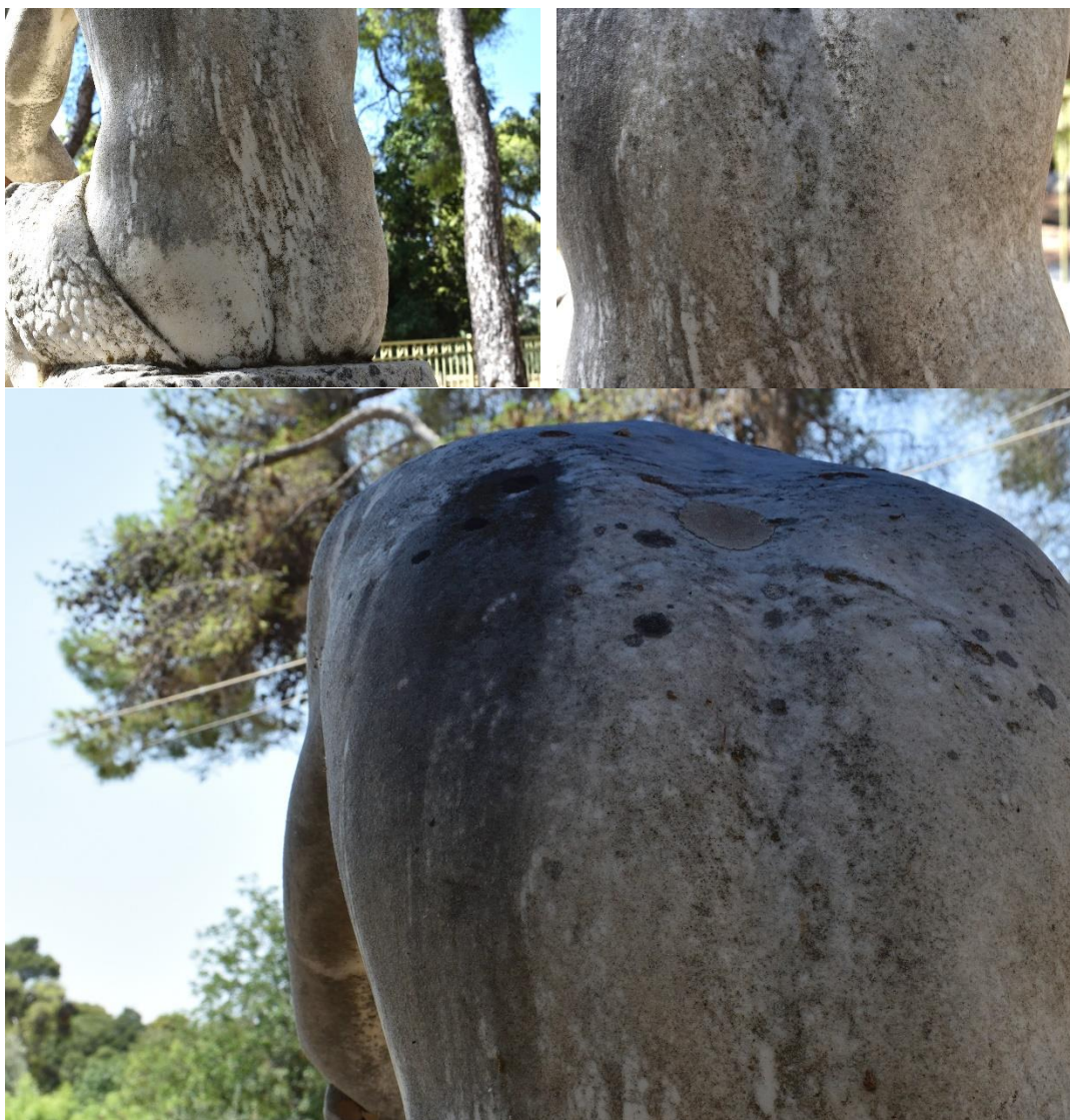
Εικ.56. Έντονες επικαθίσεις γκρι-μαύρου χρώματος στην πίσω όψη του γλυπτού του “Πάριδος” λόγω της ατμοσφαιρικής ρύπανσης, (Φωτογραφικό υλικό από προσωπικό αρχείο, Διονυσοπούλου, Πετρίδου, 2023)
