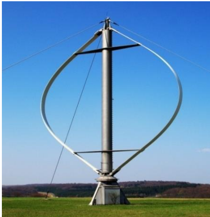
Εικόνα 2.3 - Τύπος ανεμογεννήτριας σε κάθετο άξονα
