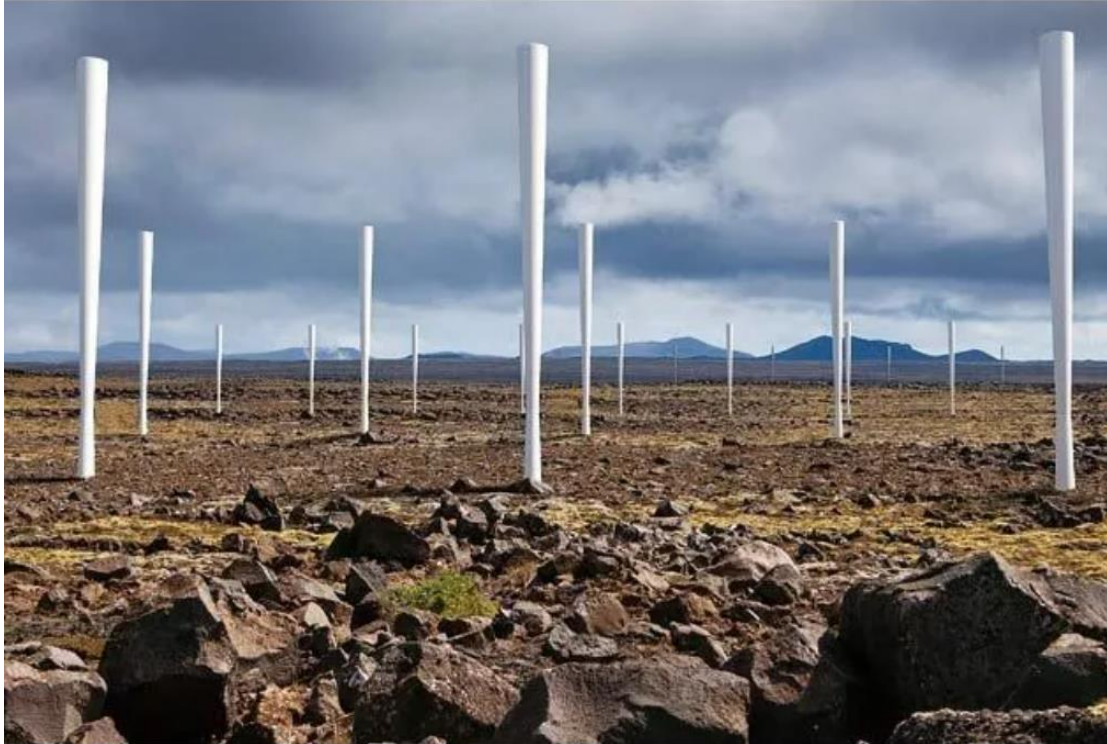
Εικόνα 2.8 - Ανεμογεννήτρια ραβδωτού τύπου - Vortex Bladeless
