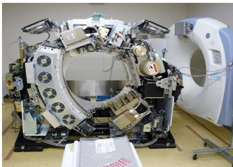
Εικόνα 31: Εσωτερικό Gantry. [CT Service Manual, GE Healthcare]
