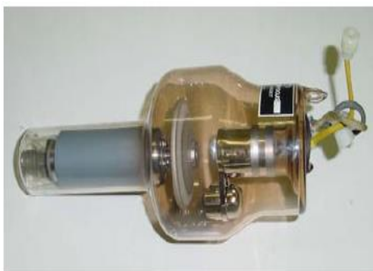
Εικόνα 19. Φωτογραφία μίας τυπικής λυχνίας περιστρεφόμενης ανόδου [Michael, G. (2001)]
