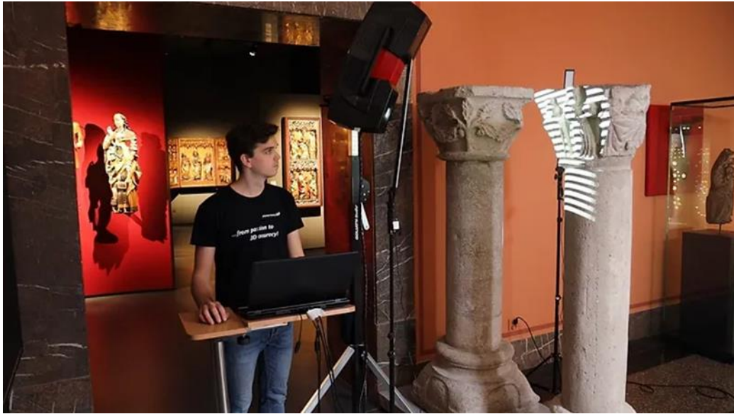
Εικόνα 36: Ενεργητική σάρωση των κιονόκρανων μέσω του σαρωτή SMARTTECH και του εξοπλισμού του στο Εθνικό Μουσείο στο Σζκζετσίν.
