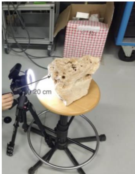
Εικόνα 40: Διαμόρφωση της κάμερας που δοκιμάστηκε στο εργαστήριο πριν από τη χρήση της στο μουσείο. Πηγή: Malik, 2022. Enhanced Cultural Experience Based On Smart Use Of 3d Digitized Cultural Heritage Artifacts. pp.58.
