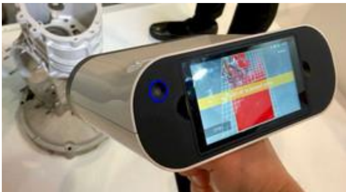
Εικόνα 51: Ο σαρωτής Artec Leo βρίσκεται πολύ κοντά στο αντικείμενο και γι' αυτό στην οθόνη του εμφανίζει το αντικείμενο με κόκκινο χρώμα. Πηγή: https://www.rubixdesign.com.au/artec-leo-laser-scanner
