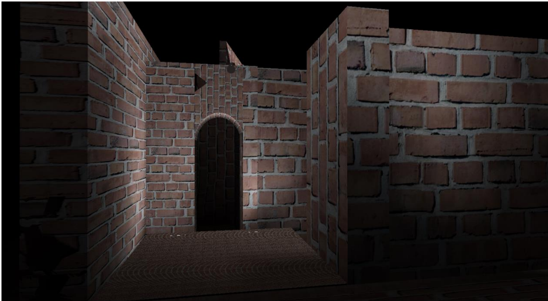
Εικόνα 6.27: Προσομοίωση φωτισμού εισόδου Β στο φωτομετρικό πρόγραμμα Relux με την τοποθέτηση ευθύγραμμων ενδοδαπέδιων φωτιστικών μπροστά από τις τοξωτές θύρες.
