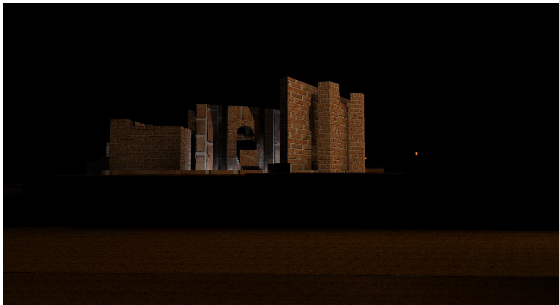
Εικόνα 6.44: Προσομοίωση φωτισμού τοιχοποιίας όπως φαίνεται από την οδό Σωτηριάδου στο φωτομετρικό πρόγραμμα Relux με την τοποθέτηση επιδαπέδιων φωτιστικών και φωτιστικών προβολέων.
