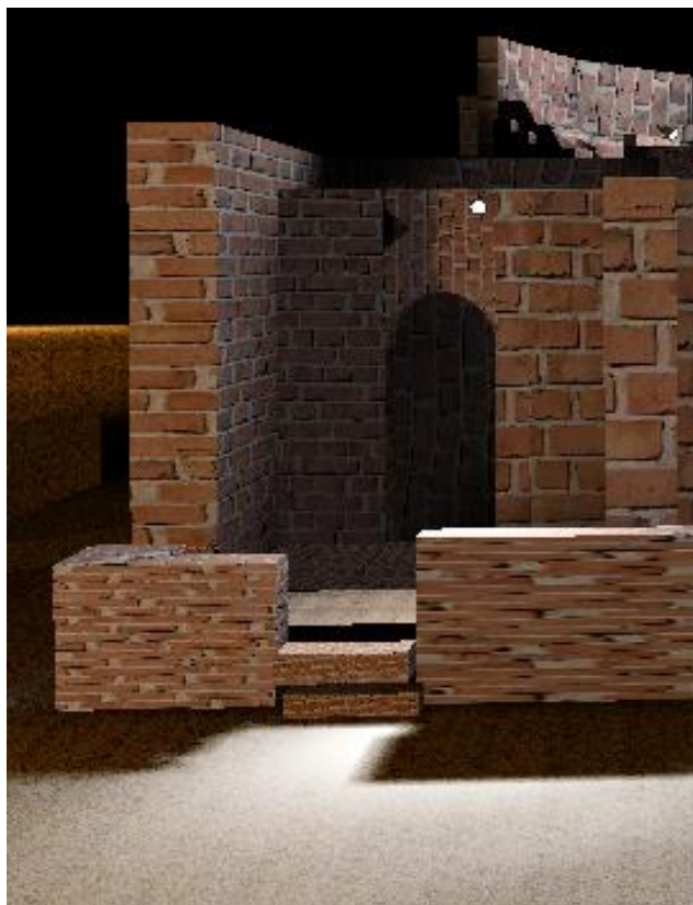
Εικόνα 6.30: Προσομοίωση φωτισμού εισόδου Α (αριστερή εικόνα) και εισόδου Β (δεξιά εικόνα) στο φωτομετρικό πρόγραμμα Relux με την τοποθέτηση φωτιστικών προβολέων πάνω στην είσοδο.
