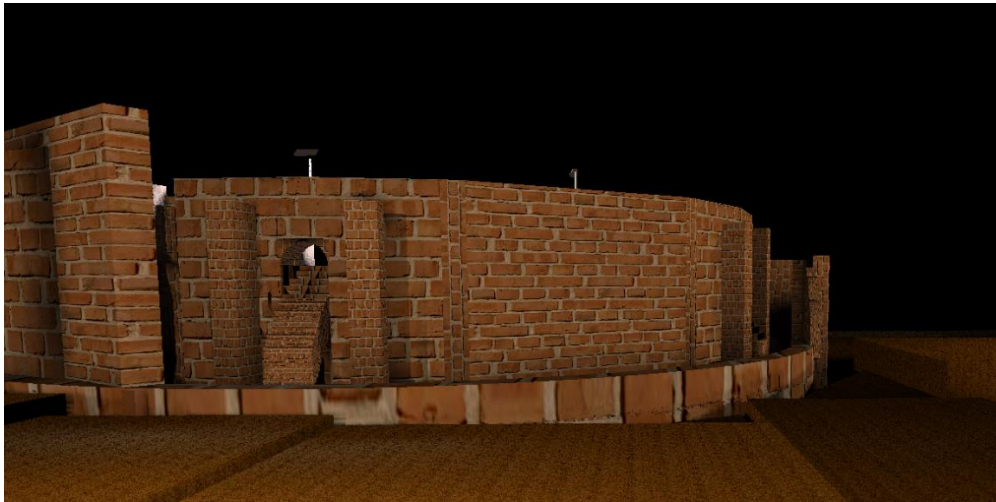
Εικόνα 6.51: Προσομοίωση φωτισμού της εξωτερικής τοιχοποιίας του Ωδείου στο φωτομετρικό πρόγραμμα Relux με την τοποθέτηση φωτιστικών προβολέων σε απόσταση από τις επιφάνειες μέτρησης επί της οδού Γεροκωστοπούλου. Τα φωτιστικά σώματα έχουν θερμοκρασία χρώματος στους 2700 K.
