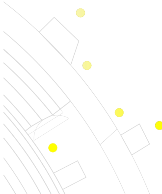
Εικόνα 6.55: Κάτοψη πάνω στην οποία σημειώνεται η θέση εγκατάστασης των φωτιστικών στο σημείο ενδιαφέροντος.
