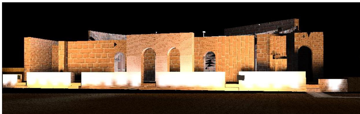
Εικόνα 6.13: Προσομοίωση φωτισμού όψης σκηνής και όψης του προσκηνίου στο φωτομετρικό πρόγραμμα Relux με την τοποθέτηση φωτιστικών προβολέων πάνω σε μεταλλικά Π.
