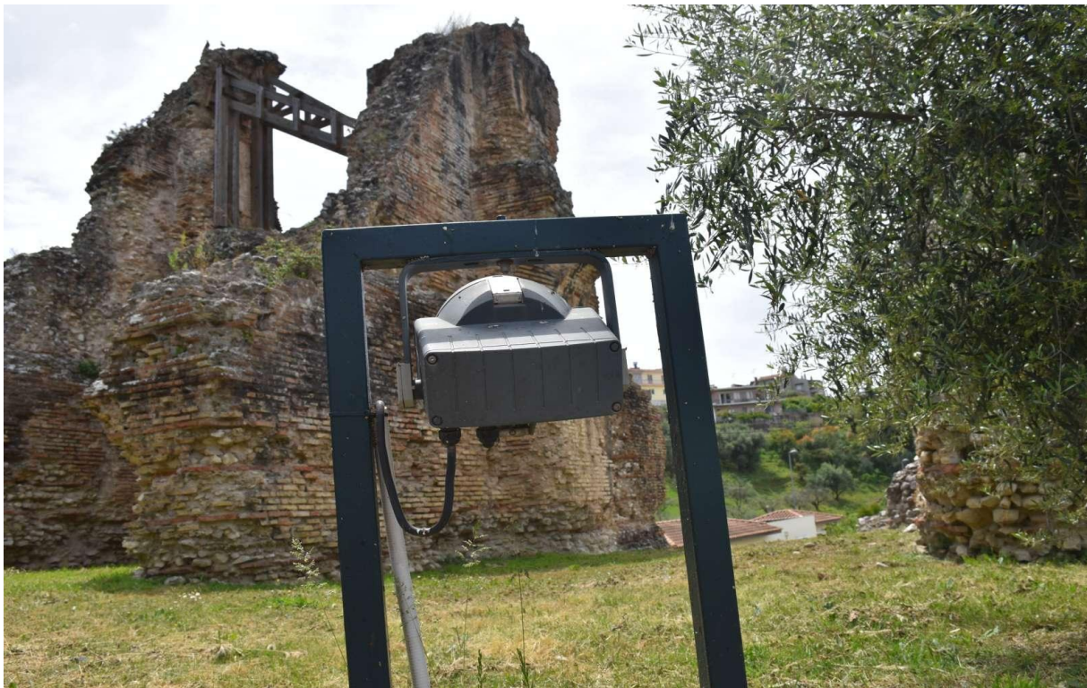
Εικόνα 4.46: Προβολέας με φακό φερνέλ για την προέκταση της δέσμης. Στόχος στις αντηρίδες της υδατογέφυρας. Πηγή: Τσαντίλα Ε.
