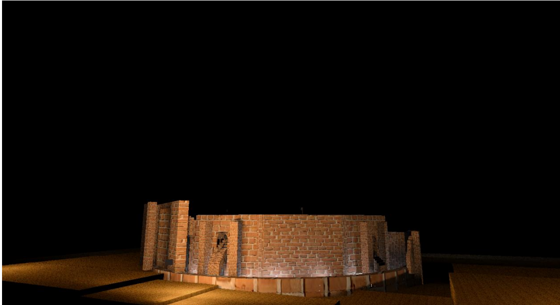
Εικόνα 6.42: Προσομοίωση φωτισμού τοιχοποιίας όπως φαίνεται από την οδό Γεροκωστοπούλου στο φωτομετρικό πρόγραμμα Relux με την τοποθέτηση επιδαπέδιων φωτιστικών και φωτιστικών προβολέων.
