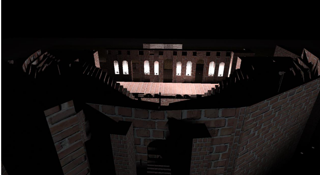
Εικόνα 6.17: Προσομοίωση φωτισμού προσκηνίου στο φωτομετρικό πρόγραμμα Relux με την τοποθέτηση φωτιστικών προβολέων πάνω στις οχτώ κόγχες της πρόσοψης της σκηνής.
