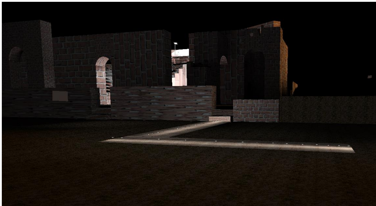
Εικόνα 6.34: Προσομοίωση φωτισμού του μονοπατιού στο φωτομετρικό πρόγραμμα Relux με την τοποθέτηση φωτιστικών στο έδαφος.
