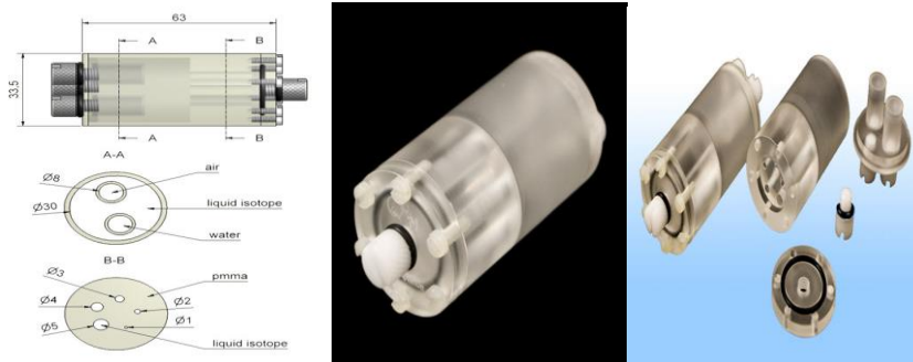
Εικόνα 3 Mouse Phantom NEMA NU 4-2008 (grm 1)
