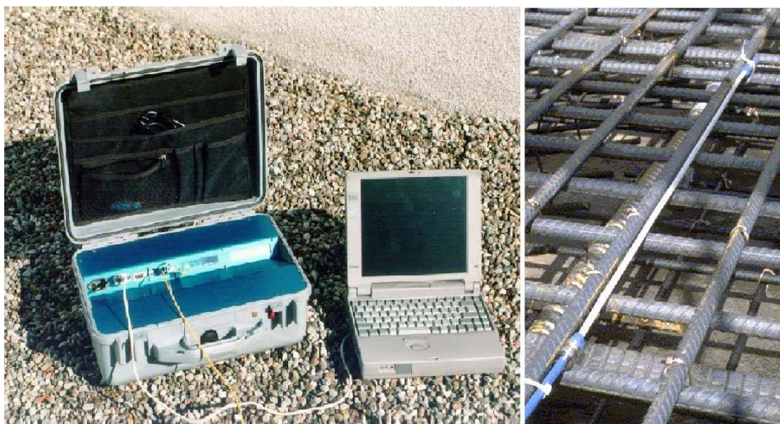
Σύστημα ανάγνωσης SOFO και εγκατάσταση σε ωπλισμό (Daniele Inaudi, 2004)
