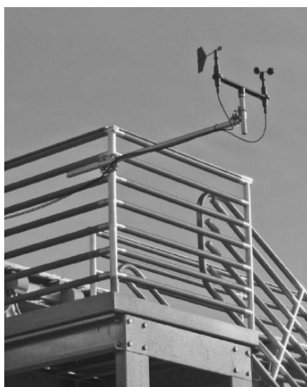
Εικόνα 8-1: Ανεμόμετρο (Frank Vignola et.al, 2020) [32]
