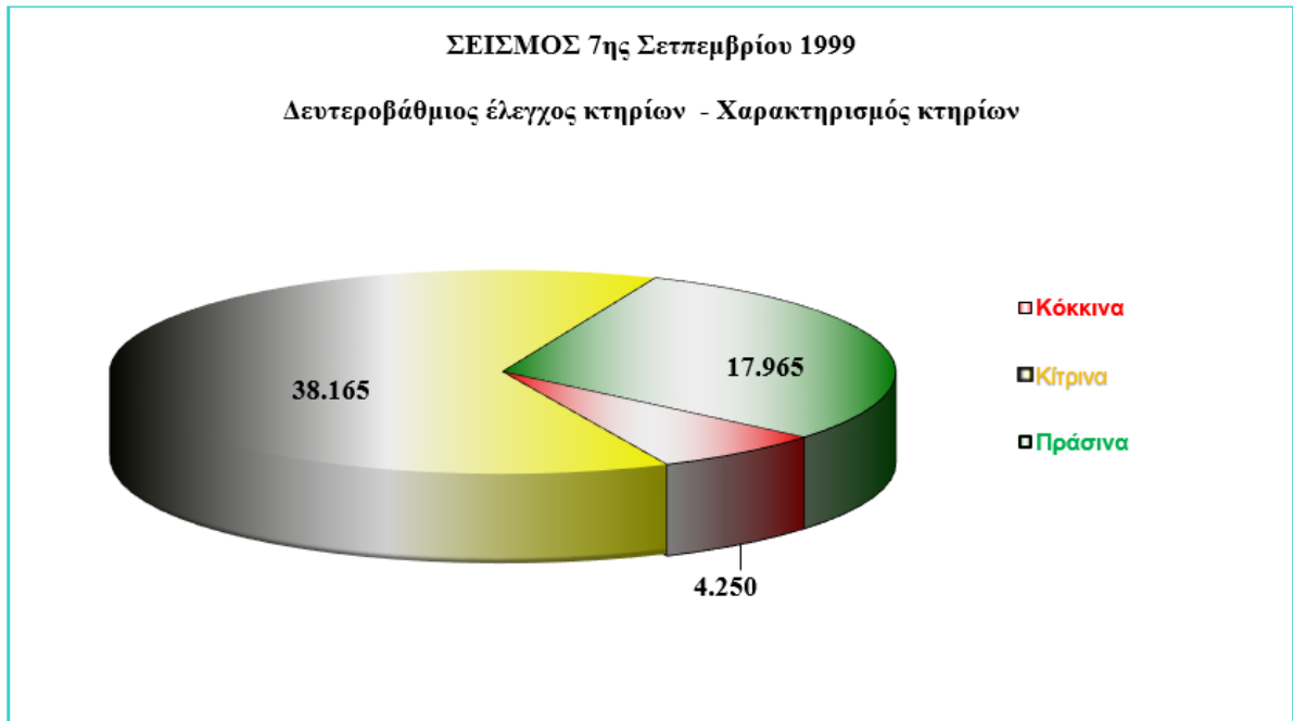
Εικόνα 19: Χαρακτηρισμός πληγέντων κτηρίων από τον σεισμό της 7ης Σεπτεμβρίου 1999 στην Αττική -Δευτεροβάθμιος έλεγχος
