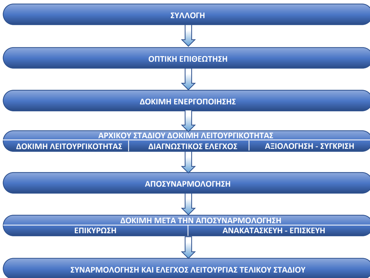
Σχήμα 22. Μεθοδολογία για τον έλεγχο της καταλληλότητας για επαναχρησιμοποίηση φορητού υπολογιστή. Πηγή : (Damian Coughlan C. F., 2018)
