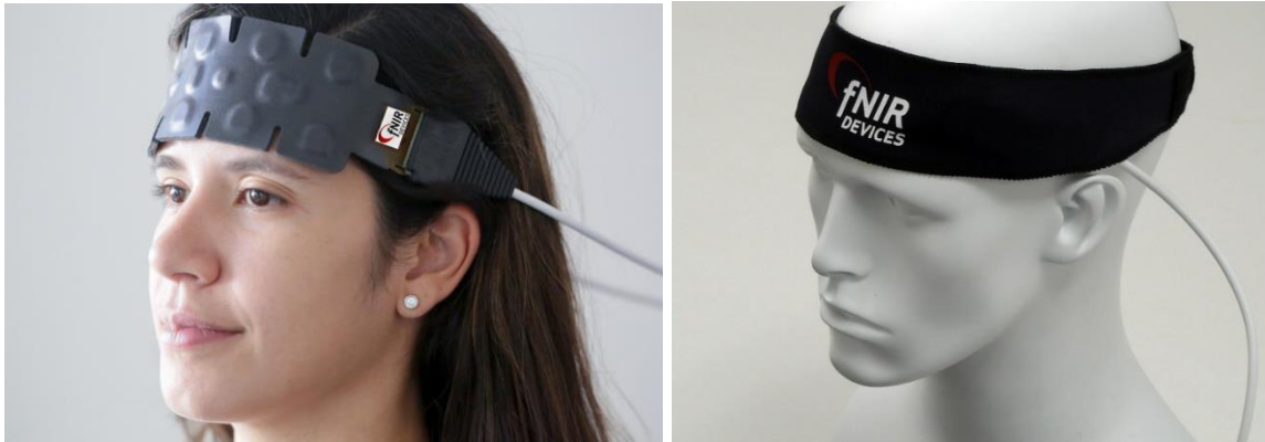
Εικόνα 9.5 [84]: στην αριστερή εικόνα απεικονίζεται η τοποθέτηση των οπτοδίων στον προμετωπιαίο φλοιό και στην δεξιά εικόνα απεικονίζεται επιπλέον το κάλυμμα σκίασης ώστε να μειωθεί ο θόρυβος του σήματος που δημιουργείται από τις εξωτερικές πηγές φωτός.
