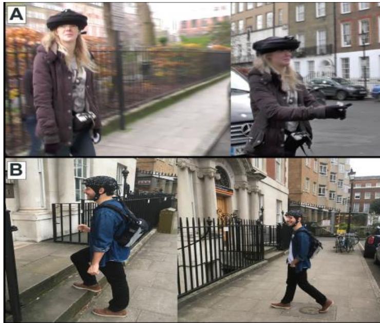
Εικόνα 4.6 [25]: Στην εικόνα A απεικονίζεται ένας συμμετέχοντας που εκτελεί την εργασία οικολογικής ενδεχόμενης μνήμης [56] στον πραγματικό κόσμο. Η εγκεφαλική δραστηριότητα του παρακολουθείται μέσω του προμετωπιαίου φλοιού από ένα φορητό, που μπορεί να φορεθεί και χωρίς ίνες σύστημα fNIRS (WOT-100, Hitachi, Ιαπωνία, τώρα πωλείται από την NeU Corporation, Ιαπωνία). Στην εικόνα B παρουσιάζεται ένας συμμετέχοντας που κινείται ελεύθερα, χωρίς περιορισμούς, εκτός εργαστηρίου. Η μέτρηση της λειτουργικής εγκεφαλικής δραστηριότητας του γίνεται μέσω του προμετωπιαίου φλοιού, από μια φορητή, που μπορεί να φορεθεί, συσκευή fNIRS (LIGHTNIRS, Shimadzu, Ιαπωνία). Ένα τέτοιο σύστημα είναι εξοπλισμένο με οπτικές ίνες που συνδέονται με μια μονάδα ελέγχου, που μεταφέρεται μέσω ενός σακιδίου.
