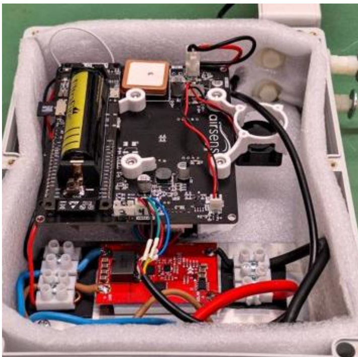
Εικόνα 24: Το κύριο σύστημα AirSensis με τον ηλιακό ρυθμιστή φόρτισης
