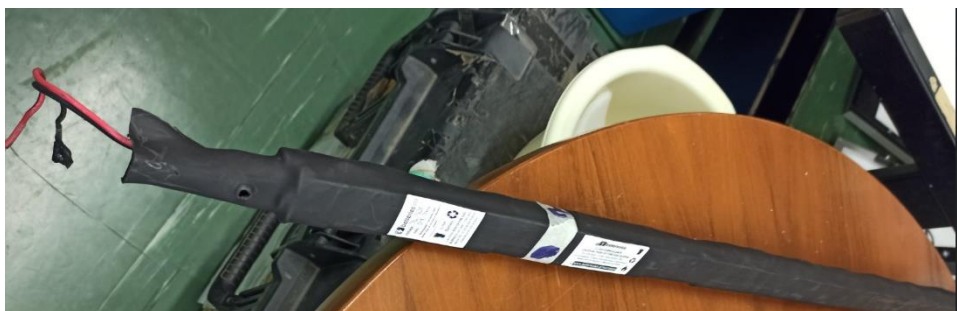
Εικόνα 41: Η μπαταρία τροφοδοσίας ενός συστήματος AirSensis
