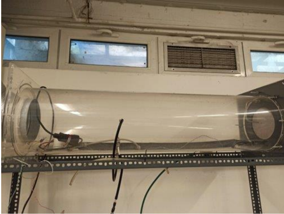
Εικόνα 47: Θάλαμος βαθμονόμησης PM του εργαστηρίου Ραδιενέργειας και Περιβάλλοντος
