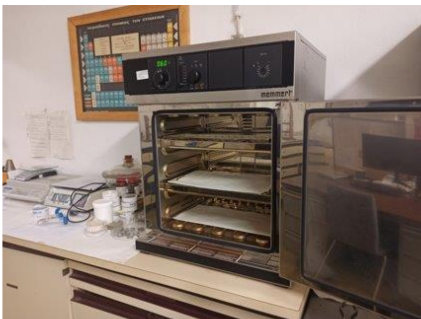
Εικόνα 49: Θάλαμος εκτέλεσης πειραμάτων βαθμονόμησης αισθητήρων θερμοκρασίας AirSensis
