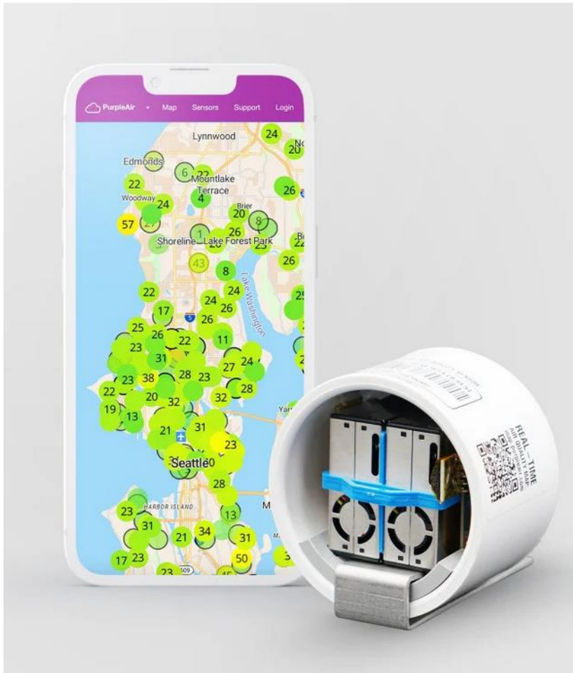
Εικόνα 15: Σταθμός μέτρησης ποιότητας του αέρα "PurpleAir Flex Air Quality Monitor"
