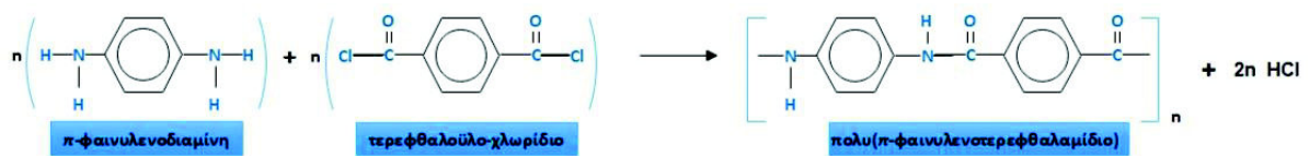
Σχήμα 1. Αντίδραση π-φαιθυλενοδιαμίνης και τερεφθαλοϋλοχλωριδίου (παραγωγή Kevlar®)
