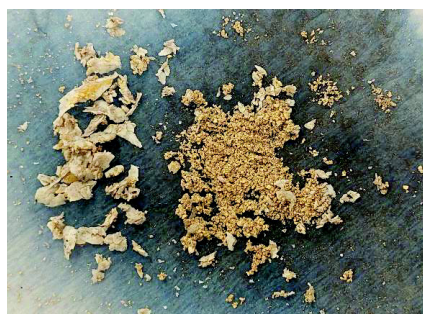
Σχήμα 25. Βαμμένο δείγμα με βαφή 100% ακατέργαστης χρωστικής (εκχυλισμένη αιματεΐνη) επί του βάρους του πολυμερούς
