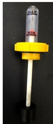
Εικόνα 21: Όργανο μέτρησης στάθμης υγρών
