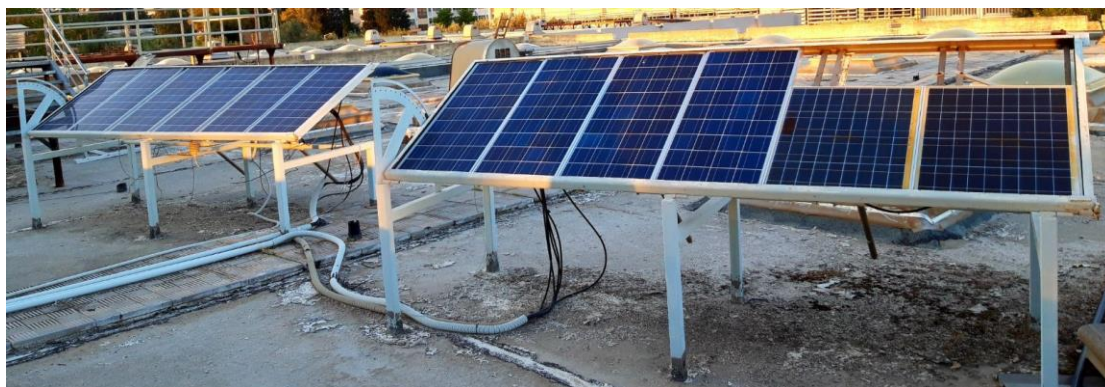
Εικόνα 11: Πειραματική διάταξη φωτοβολταϊκής συστοιχίας
