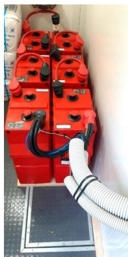
Εικόνα 7: Πειραματική Διάταξη Συσσωρευτών του Εργαστηρίου
