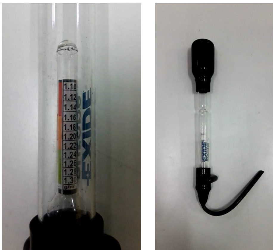
Εικόνα 22: Όργανο μέτρησης πυκνότητας ηλεκτρολυτών με βαθμονόμηση
