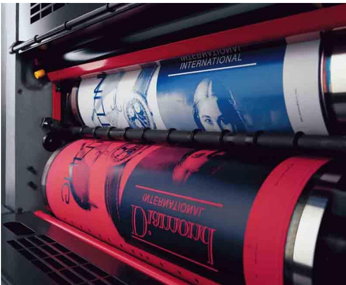
Εικόνα 20: Κύλινδρος της offset. Επάνω διακρίνεται ο κύλινδρος της εκτυπωτικής πλάκας και κάτω ο κύλινδρος καουτσούκ(μεταφοράς). Πηγή:
