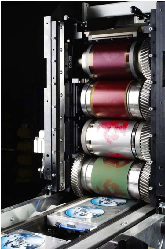
Εικόνα 21: Εξειδικευμένη μονάδα offset που ειδικεύεται στην εκτύπωση CDS, DVDS. Διακρίνεται στο κάτω μέρος ο κύλινδρος καουτσούκ (μεταφοράς).
