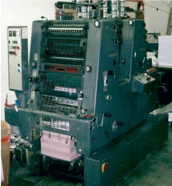
Εικόνα 23: Μηχανή offset. Διακρίνεται κάτω αριστερά το πατάρι εξαγωγής των τυπωμένων εκτυπώσεων.
