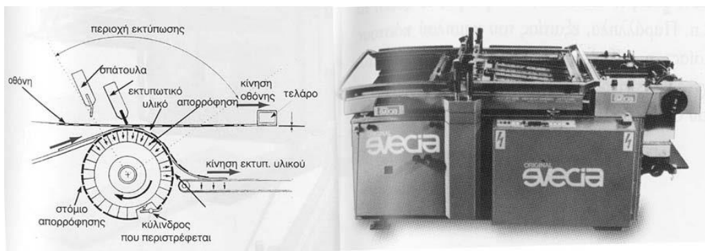
Εικόνα 33: Σχηματική παράσταση εκτύπωσης κυλινδρικής μηχανής μεταξοτυπίας και κυλινδρική μηχανή μεταξοτυπίας.
