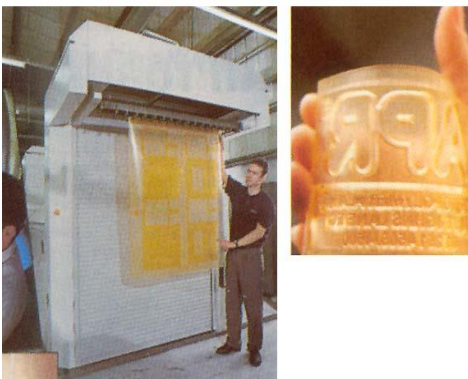
Εικόνα 62: Φλεξογραφικά κλισέ. Πηγή: https://www.bizdim.gr/index.php/tehnologiaektyposeon/thebook/35-flexo
