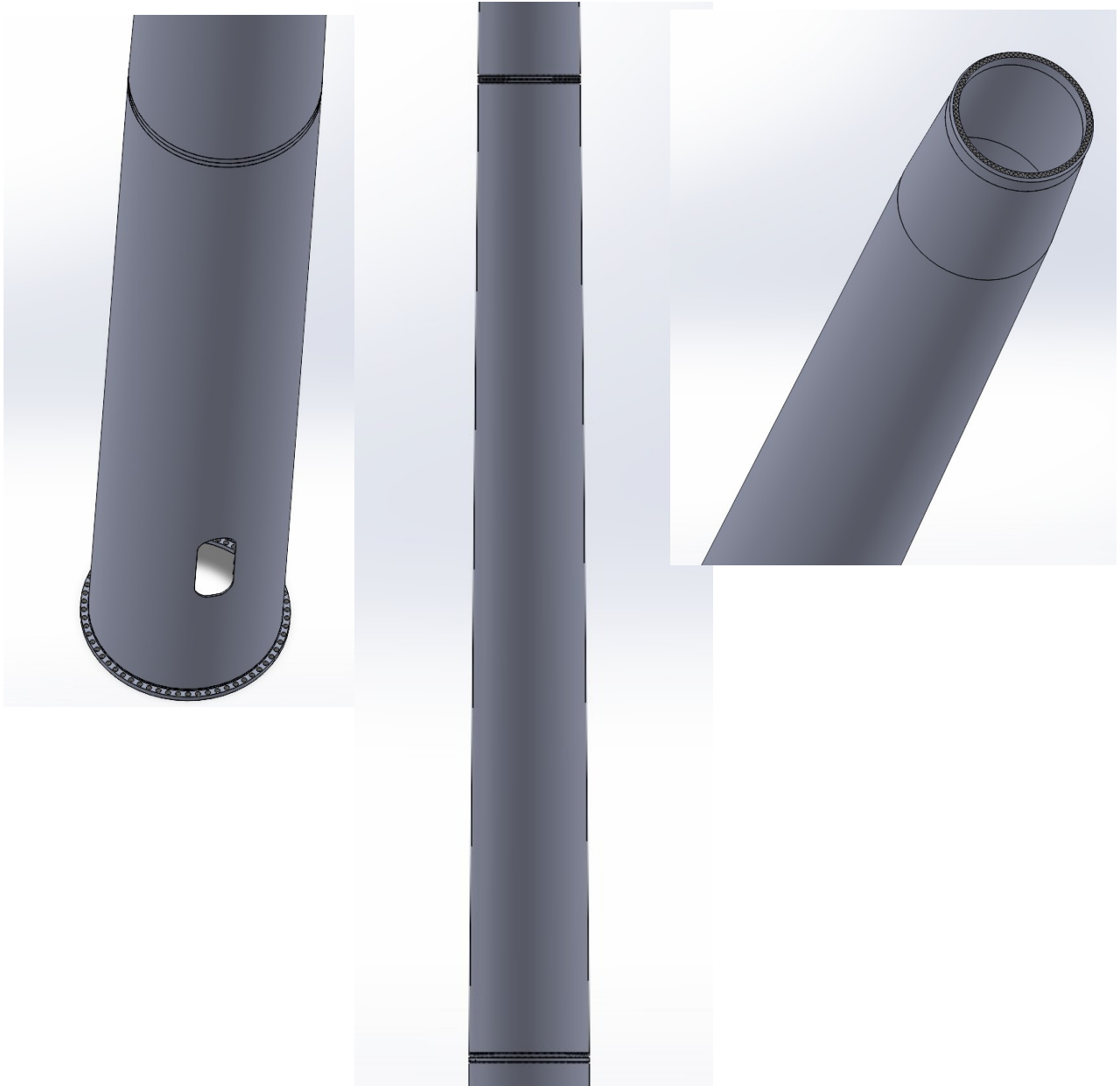
Εικόνα 5.2.9 : Τα 3 κομμάτια του πύργου μαζί με τις φλάντζες.
