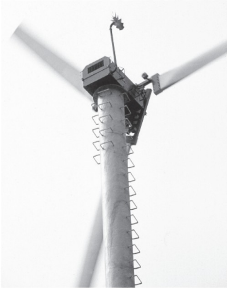
Εικόνα 1.1.2 : Αισθητήρας κατεύθυνσης ανέμου σε μια πρώιμη ανεμογεννήτρια Lagerwey (Beurskens, 2014).
