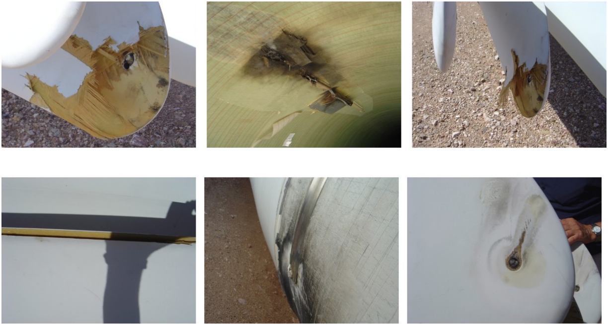
Εικόνα 3.3 : Βλάβες πτερυγίων από κεραύνιο πλήγμα (Πηγή: Γεώργιος Λευθεριώτης - Ανανεώσιμες Πηγές Ενέργειας-Πανεπιστήμιο Πατρών)
