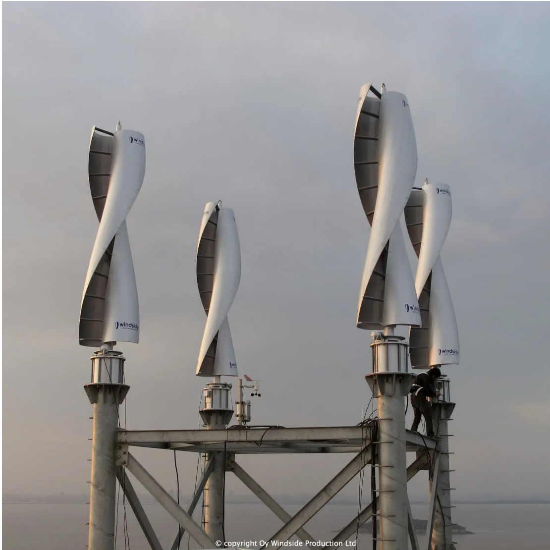
Εικόνα 2.1.3α: Τέσσερις Windside WS-4B ανεμογεννήτριες κάθετου άξονα τύπου Savonius που παράγουν ενέργεια για ένα σταθμό ραντάρ στην Κίνα. (Πηγή: https://windside.com/ )
