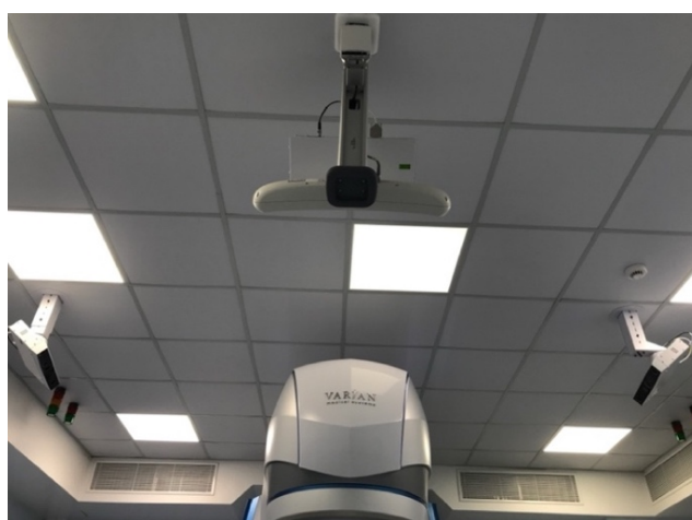
Εικόνα 26: Υπέρυθρες κάμερες του συστήματος SGRT, οι AlignRT της εταιρείας VisionRT (Νοσοκομείο Mediterraneo).
