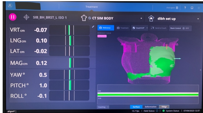
Εικόνα 38: Εικόνα ανίχνευσης επιφάνειας απαιτούμενου ROI για ακτινοθεραπεία αριστερού μαστού, με χρήση υπέρυθρων της τεχνικής SGRT, της εταιρίας VisionRT (Νοσοκομείο Mediterraneo).
