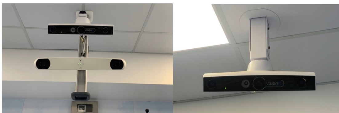
Εικόνα 27: Κεντρική και πλάγιες υπέρυθρες κάμερες του συστήματος SGRT, οι AlignRT της εταιρείας VisionRT (Νοσοκομείο Mediterraneo).
