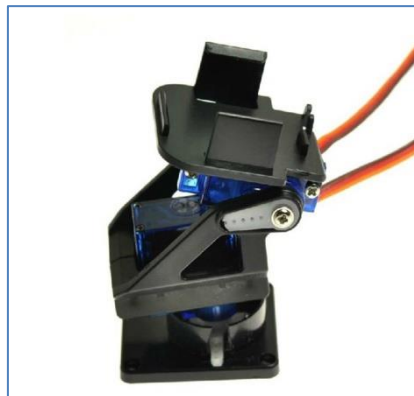
Εικόνα 10. Μηχανισμός στήριξης - κίνησης κάμερας
