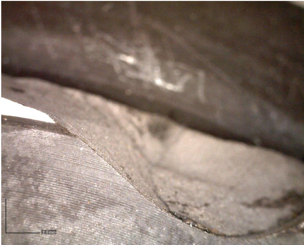
Εικόνα 75 Ράουλο CALDIE μερία αποκόλλησης "μ1.2", μεγέθυνση X20
