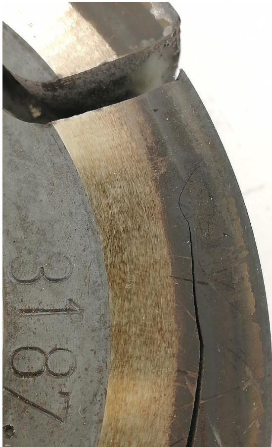
Εικόνα 63 Δοκίμιο CALDIE όψη Α εστίαση στο τμήμα συγκράτησης Εικόνα 64 Χρωματισμός και συσχέτιση με τη θερμοκρασία [8] (Hamilton)
