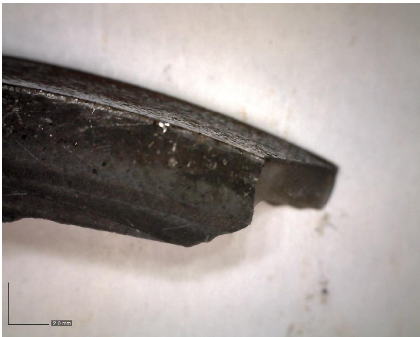
Εικόνα 72 Ράουλο CALDIE τμήμα αποκόλλησης "M 1. 2", μεγέθυνση X20 ινώδεις ζώνες
