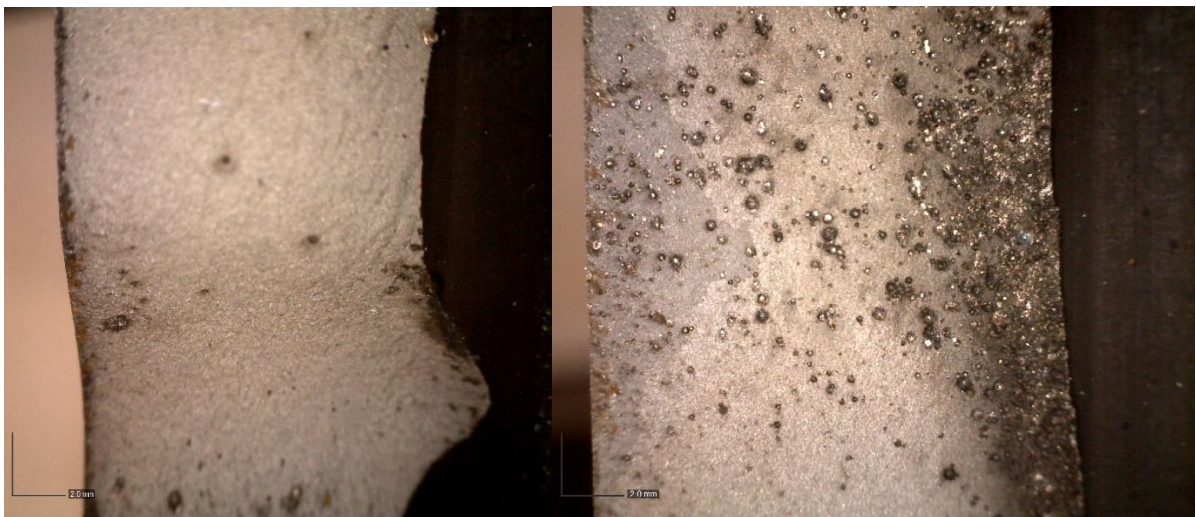
Εικόνα 81 Τμήμα "Μ1.2", ψαθυρή ζώνη (επιφάνεια θραύσης)
