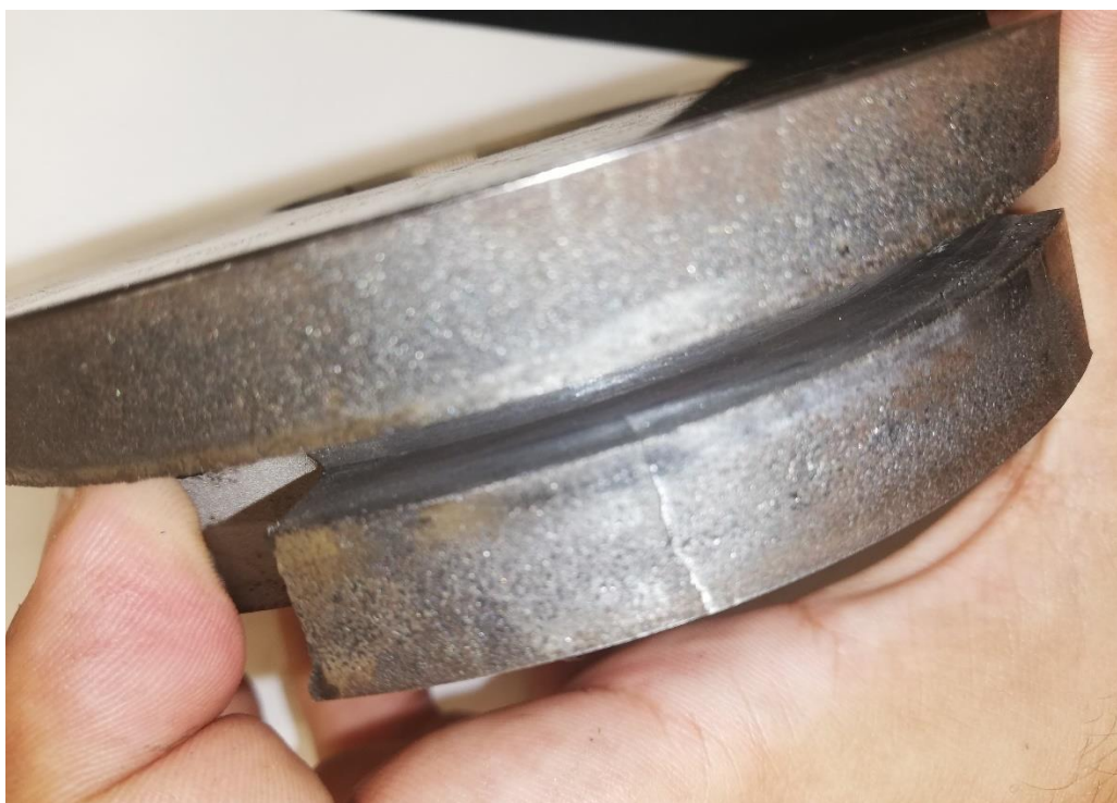
Εικόνα 67 Ρηγμάτωση που ξεκινάει απο τη σχισμή μέσα και μεταφέρεται προς την επιφάνεια
