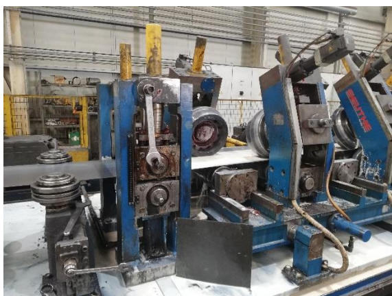
Εικόνα 49 πρώτο στάδιο διαμορφώσεως από έλασμα
