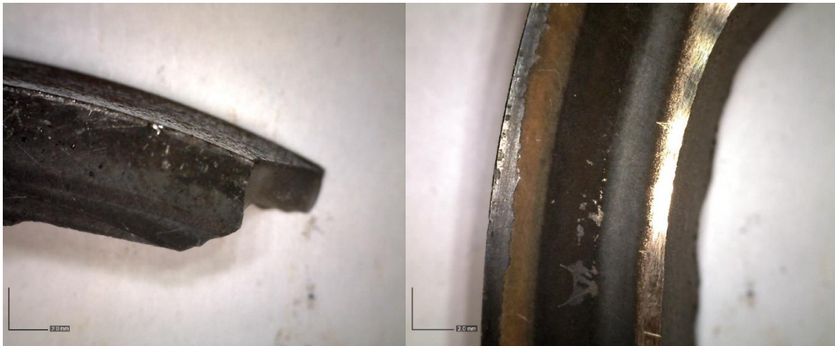
Εικόνα 79 Τμήμα αποκόλλησης "Μ 1.2", μεγέθυνση Χ20, Εικόνα 80 Θερμικά επηρεαζόμενη ζώνη, ινώδης περιοχή
