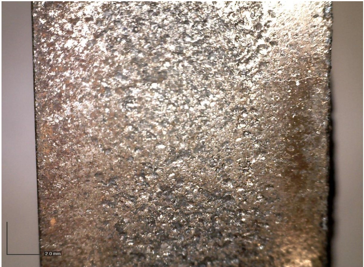
Εικόνα 73 Ράουλο CALDIE τμήμα αποκόλλησης "μ1.2", μεγέθυνση X20 οξειδώσεις επιφανείας
