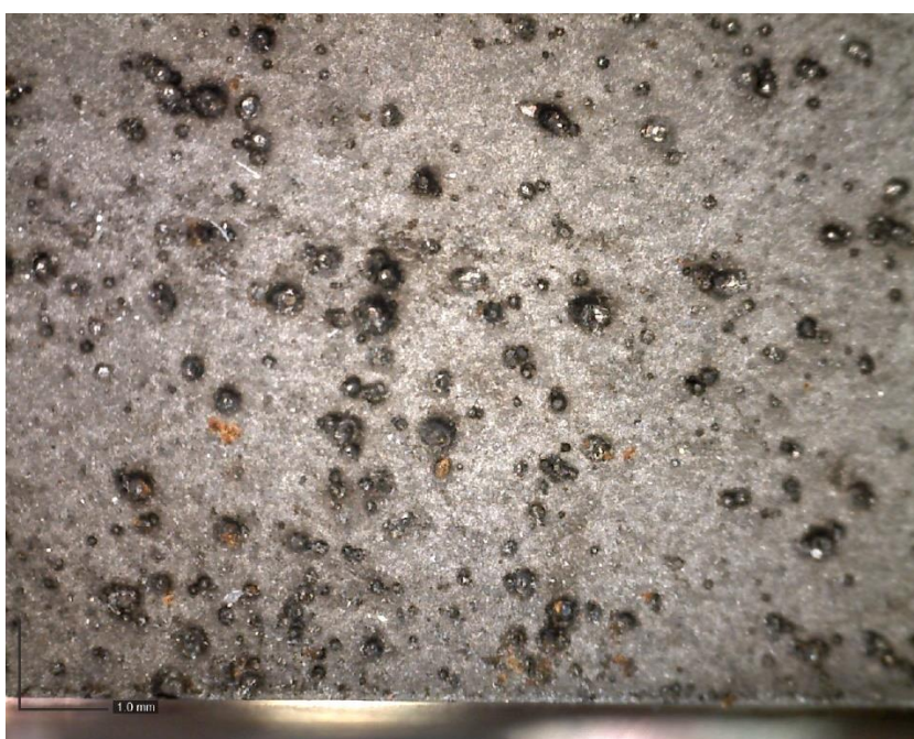
Εικόνα 78 Ράουλο CALDIE τμήμα αποκόλλησης "μ 1.2", μεγέθυνση X40
