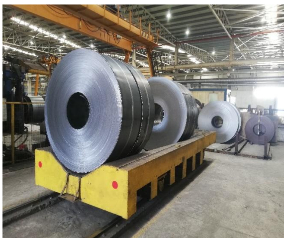
Εικόνα 47 μεταφορά ελάσματος απο τύλιγμα σε στροφέιο
