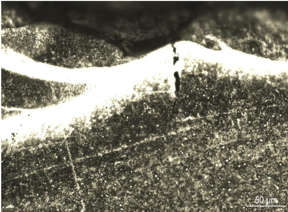
Εικόνα 112. Δοκίμιο "μ . 2" , μεγέθυνση X500, περικρυσταλλική θράυση
