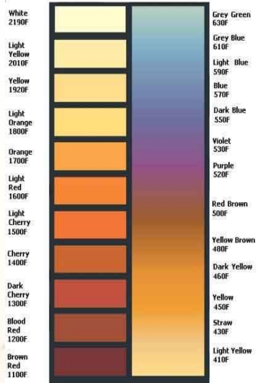
Εικόνα 63 Δοκίμιο CALDIE όψη Α εστίαση στο τμήμα συγκράτησης Εικόνα 64 Χρωματισμός και συσχέτιση με τη θερμοκρασία [8] (Hamilton)
