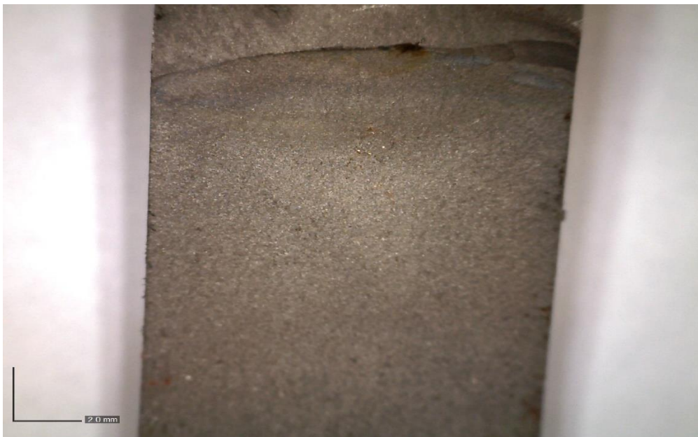
Εικόνα 76 Ράουλο CALDIE τμήμα αποκόλλησης "μ1.2", μεγέθυνση X20, ψαθυρή επιφάνεια θραύσης
