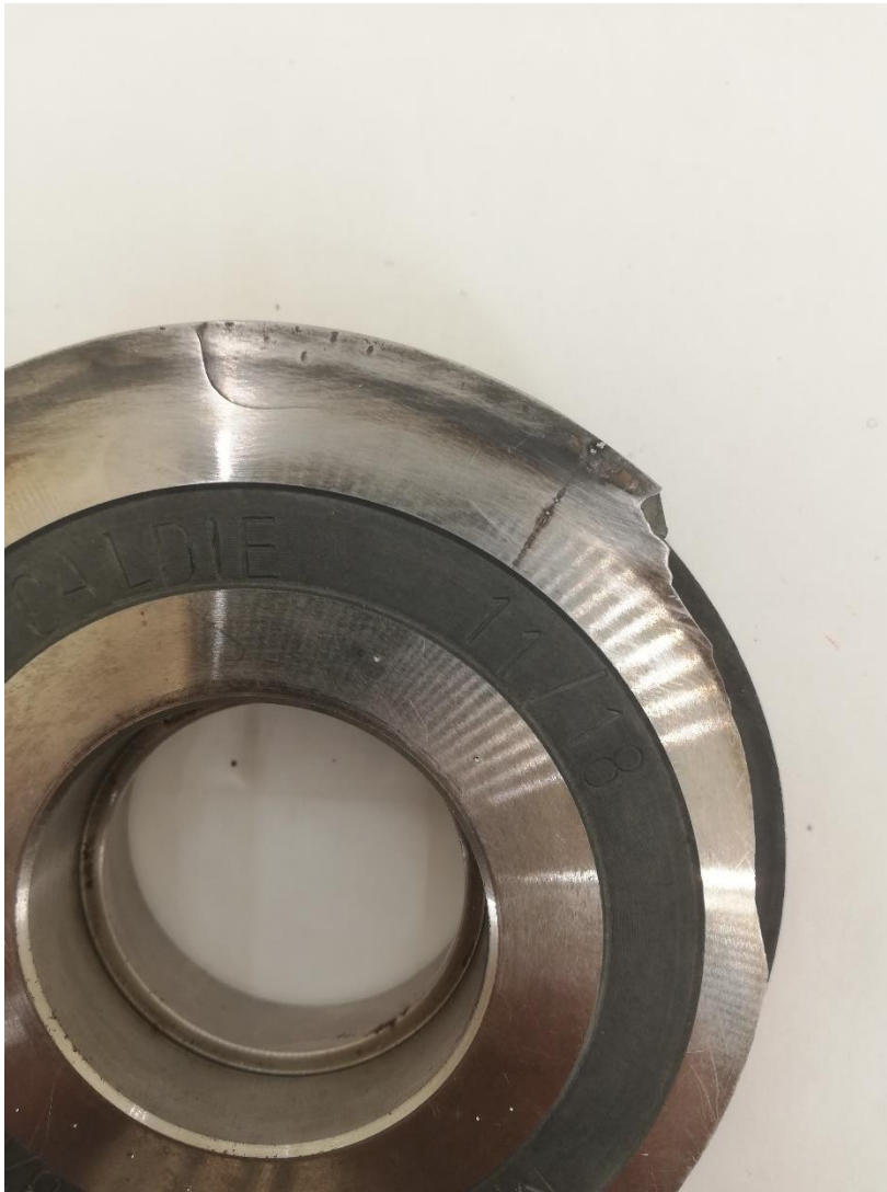
Εικόνα 68 Συνέχεια διάδοσης της ρωγμής και μεταφορά της στην εξωτερική επιφάνεια του ράουλου όπου σταματάει
