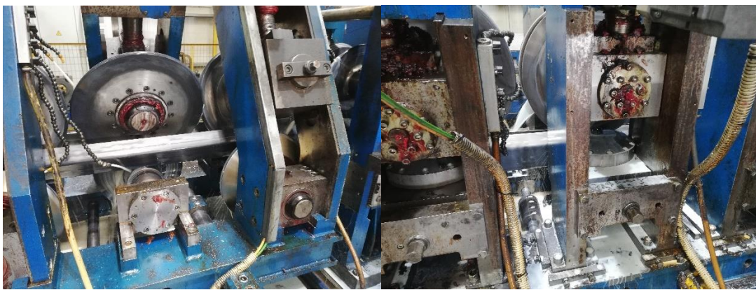
Εικόνα 53 Έκτο στάδιο κάμψη σε τετράγωνη διατομή Εικόνα 54 Έβδομο στάδιο τελικά ράουλα πριν τη συγκόλληση
