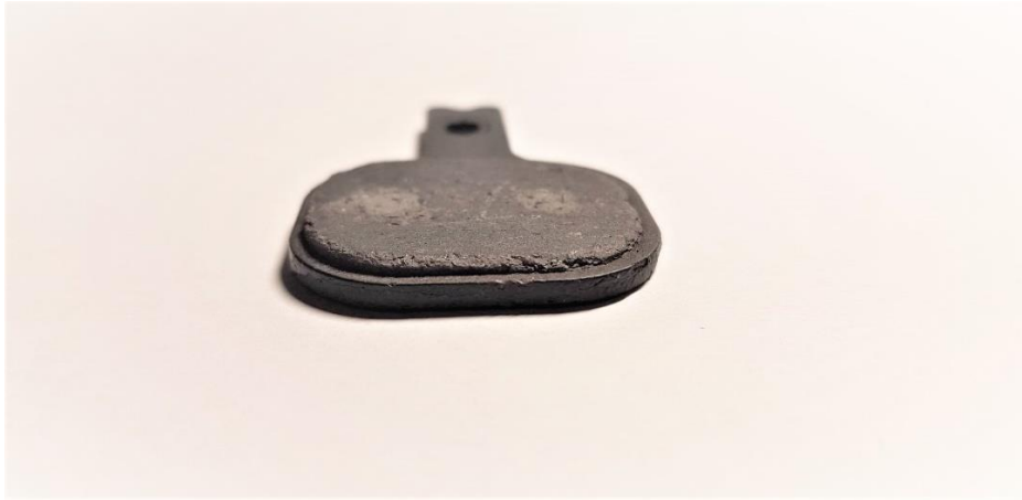
Εικόνα 19: Δείγμα φθοράς και εμφάνιση κωνικότητας στο τακάκι.
