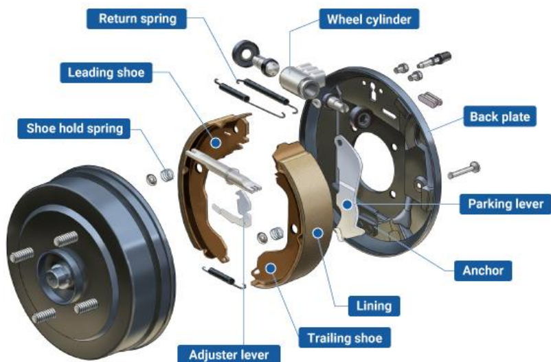
Εικόνα 4: Τρισδιάστατη απεικόνιση των μερών του ταμπόρο.
