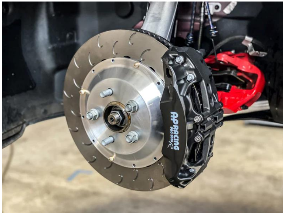
Εικόνα 9 : Σύγχρονο 6-πιστονο σύστημα πέδησης από την AP Racing.
