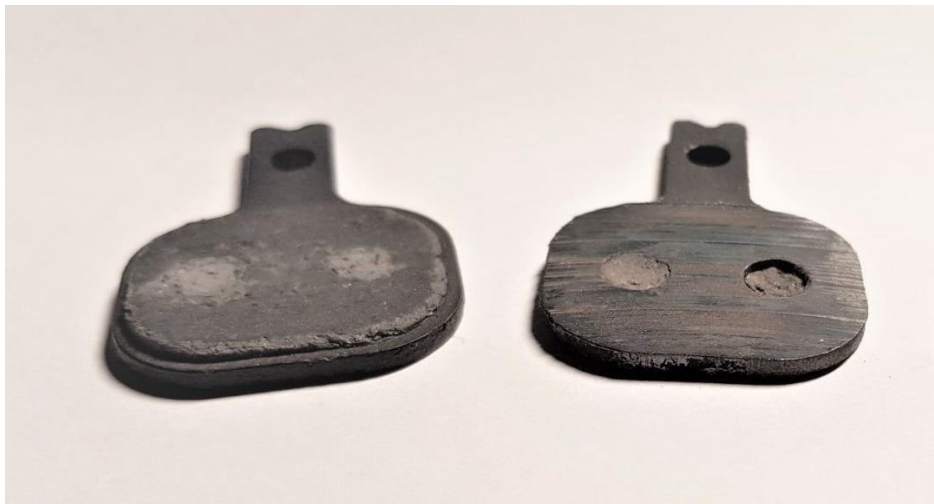
Εικόνα 20: Παράδειγμα διαφορετικής φθοράς αναμεσά στα δυο τακάκια EBC (GPFAX184HH) της ίδιας δαγκάνας.
